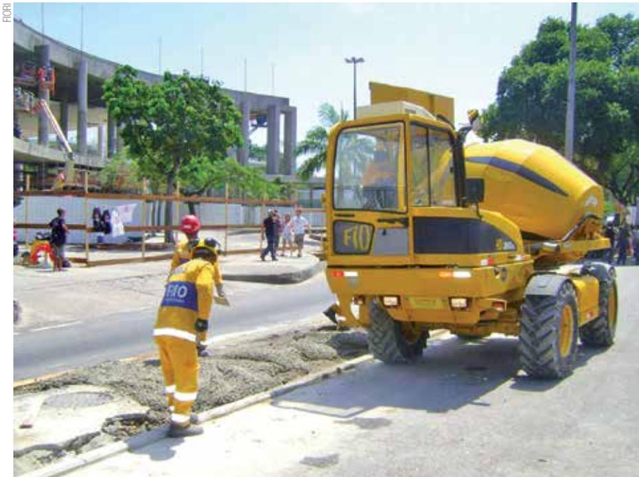
Modelo Fiori DB 260 SL oferece sistema de pesagem e controle do cimento, água, aditivos e agregados
