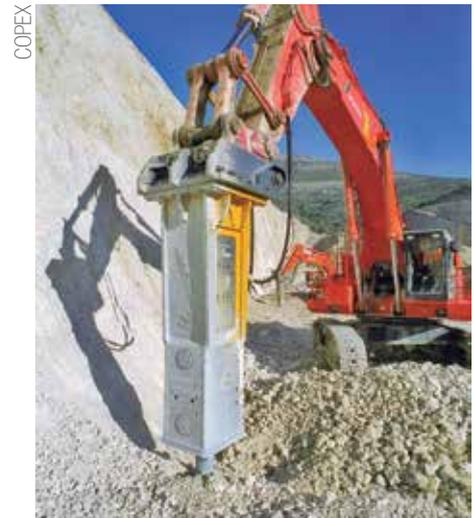
**Rompedor para demolição** e desmonte
