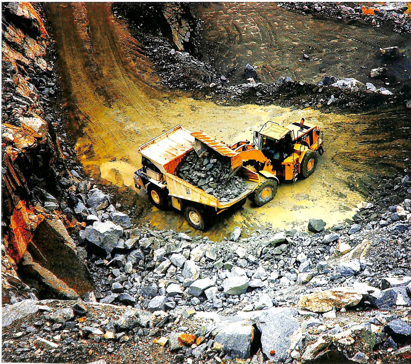
Carregamento da pedra bruta para britagem com utilização de dois equipamentos terceirizados
