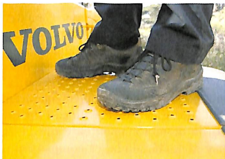
Piso especial: evita escorregões
