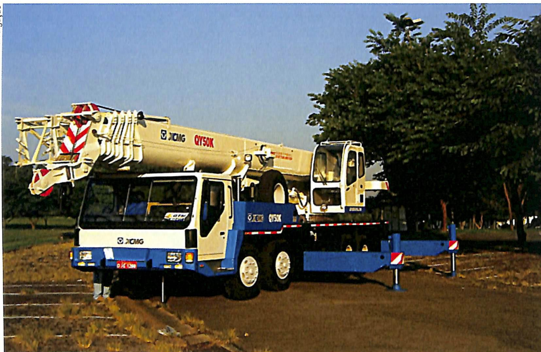
Truck crane é totalmente computadorizado e tem peso total de apenas 38.580 kg.
