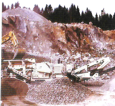
Planta móvel LT110S para britagem e peneiramento.
