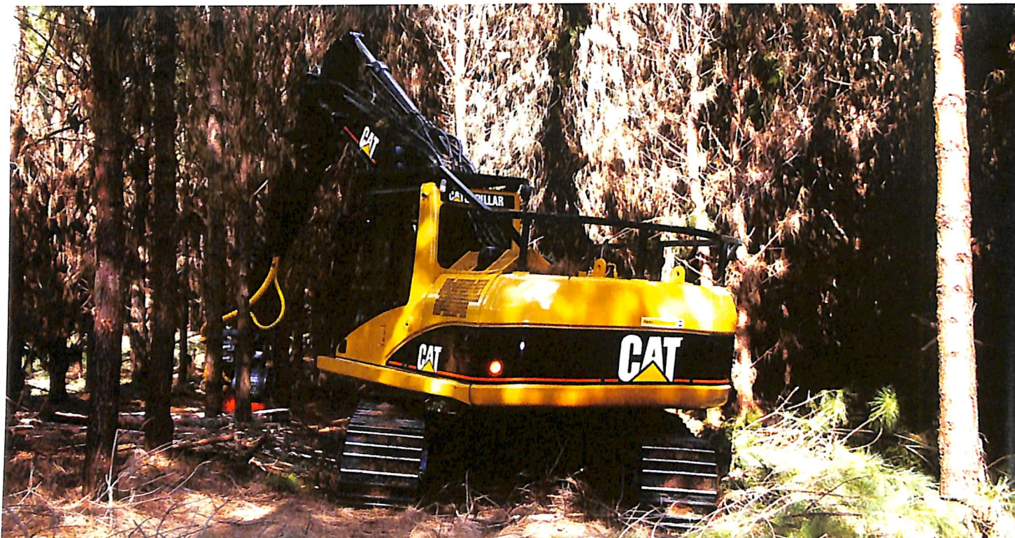
Raio de giro reduzido garante flexibilidade e manobras rápidas no interior da floresta.
