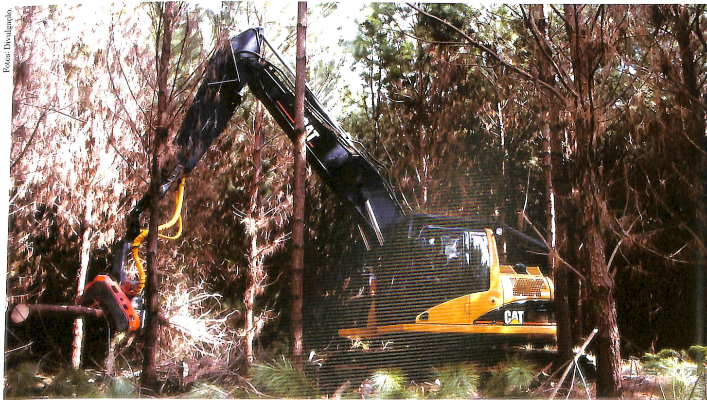
320 C L: desenvolvimento da Caterpillar Brasil para corte seletivo de madeira.
