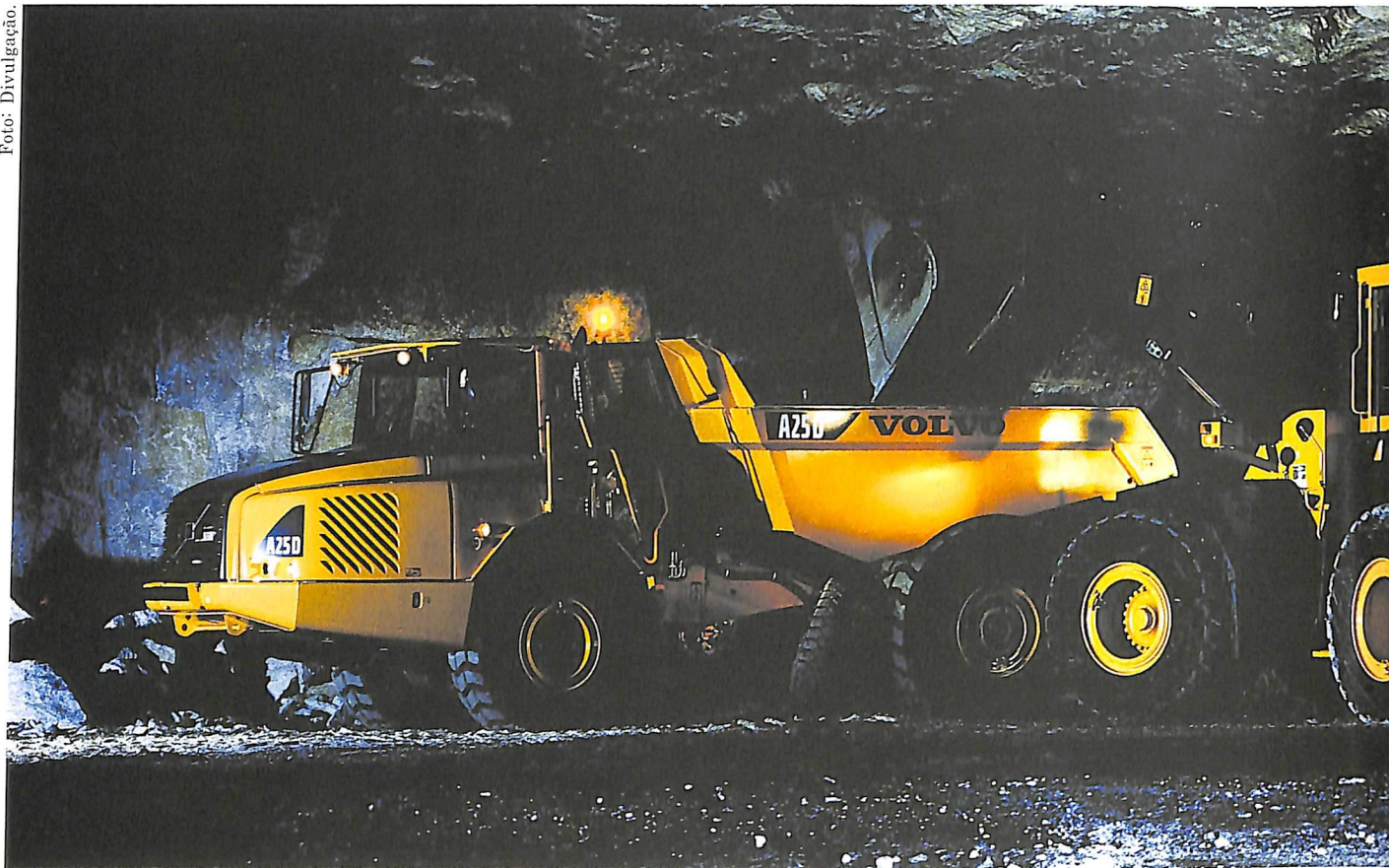
Áreas confinadas: giro de 180° em apenas 9,5 metros.
