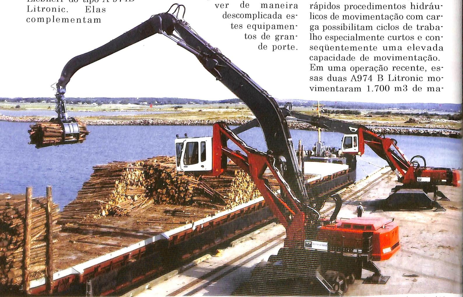
As escavadeiras móveis Liebherr A974 B, com peso operacional de 119 t, no porto de Varberg: as maiores e mais potentes escavadeiras móveis em termos mundiais e concebidas especialmente para a movimentação de materiais.
