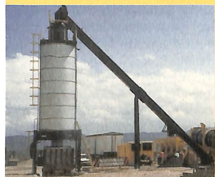
Silo de Estocagem Fixo 100 ton com aquecimento
