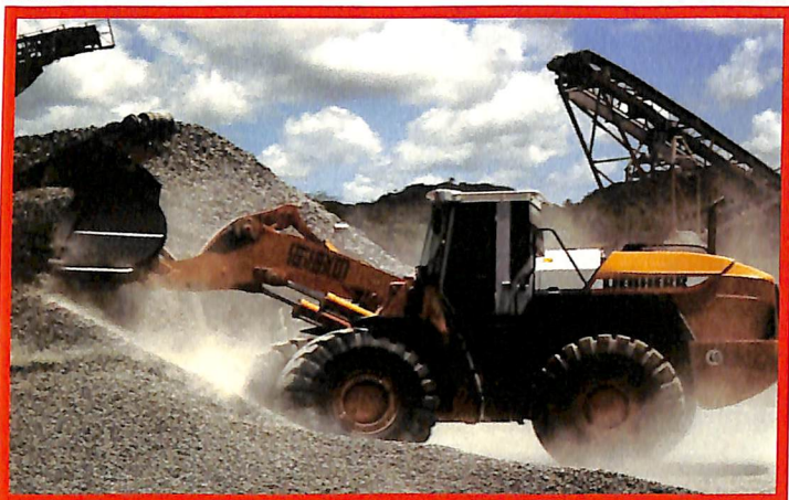
L580 Cucharón de 5,5 m 3 , peso en operación de 24,5 t y consumo medio de 18,5 litros/hora
