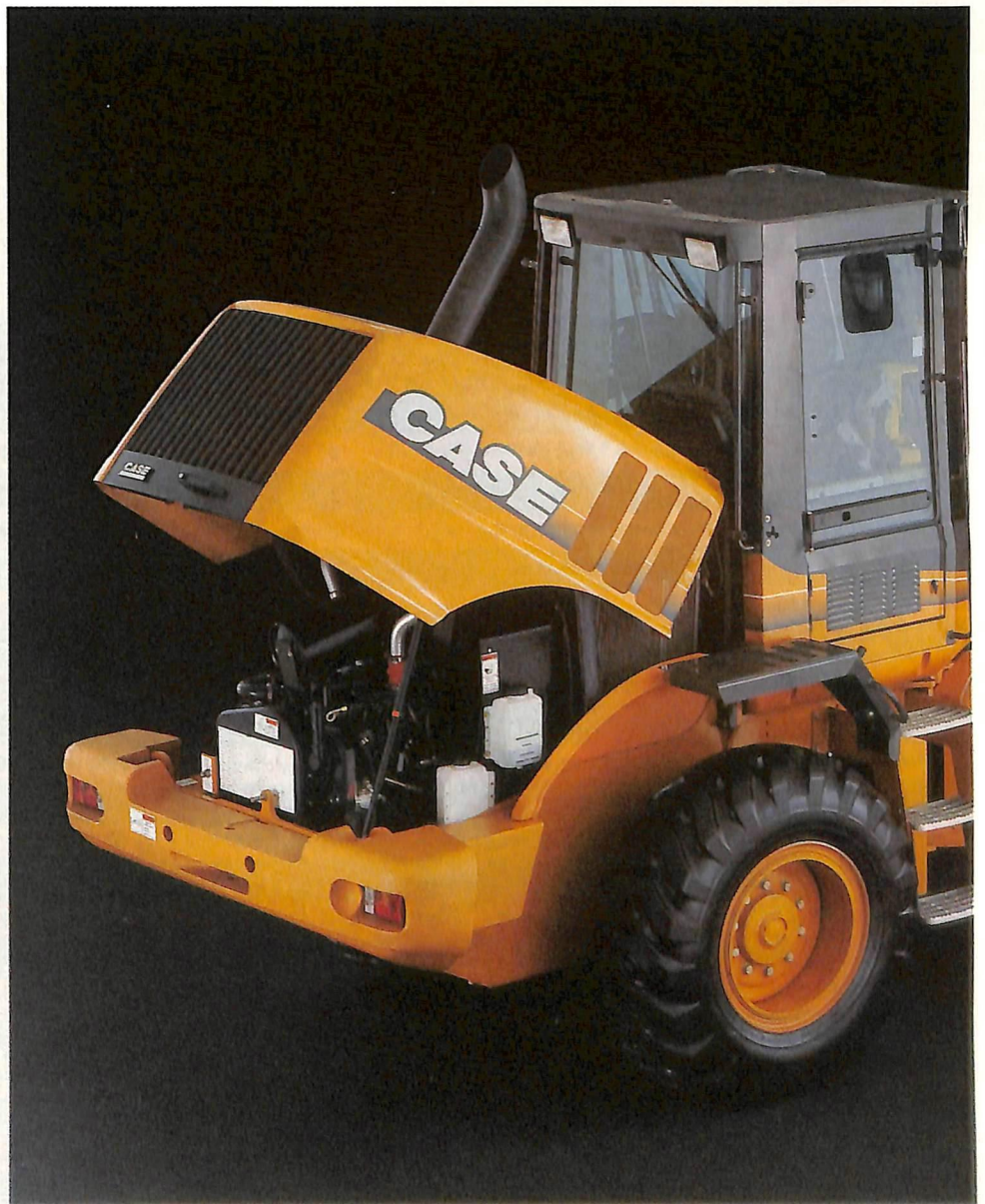
Exclusivo sistema de enfriamiento ubicado atrás de la cabina
