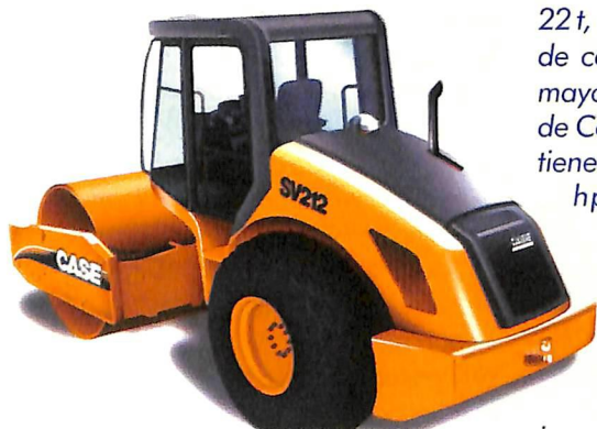
SV212: compactador Case de 11 a 13,5 t SV212: compactador Case de 11 a 13,5 t
