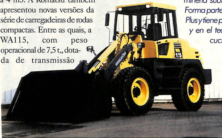
WA 115: transmissão hidrostática WA115: transmisión hidrostática
