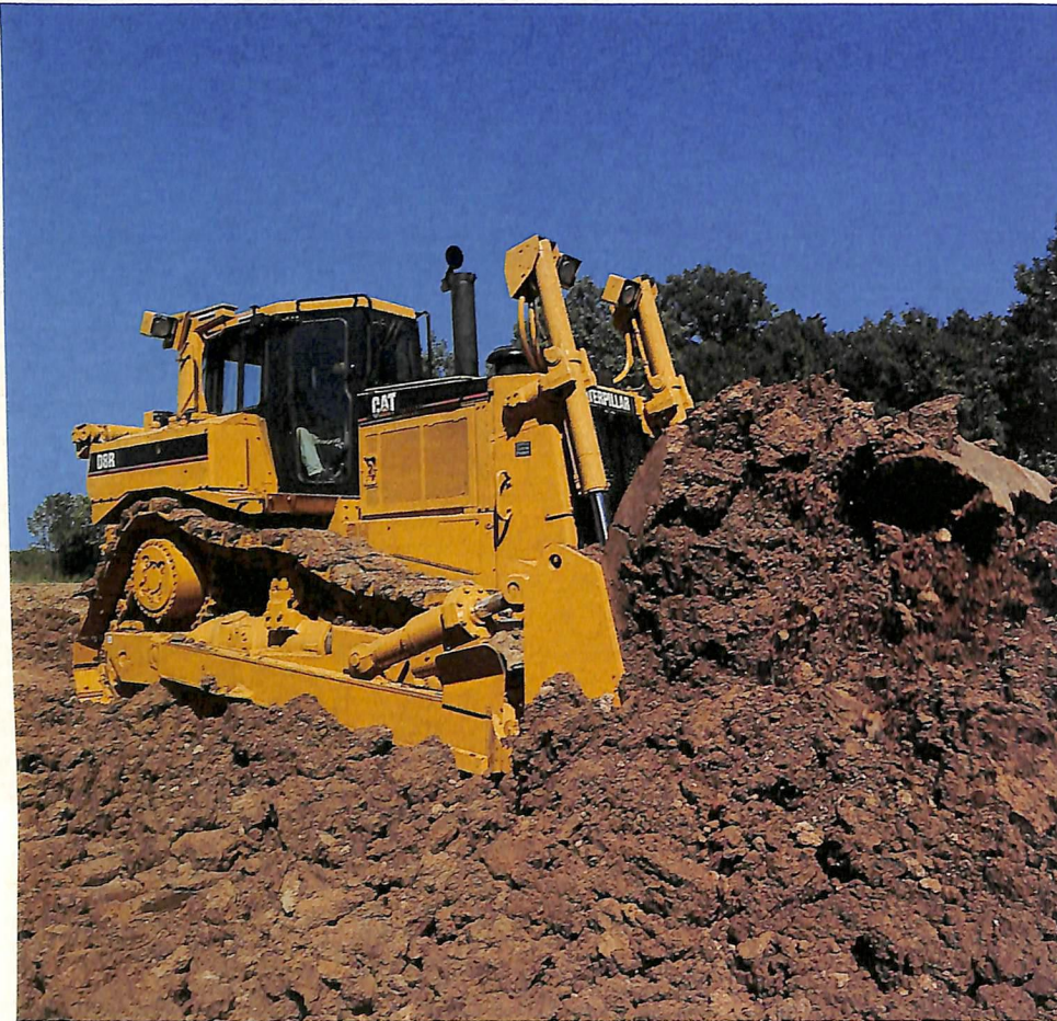
D8 R: 39 t e potência de 310 HP D8 R: 39 t y potencia de 310 hp
