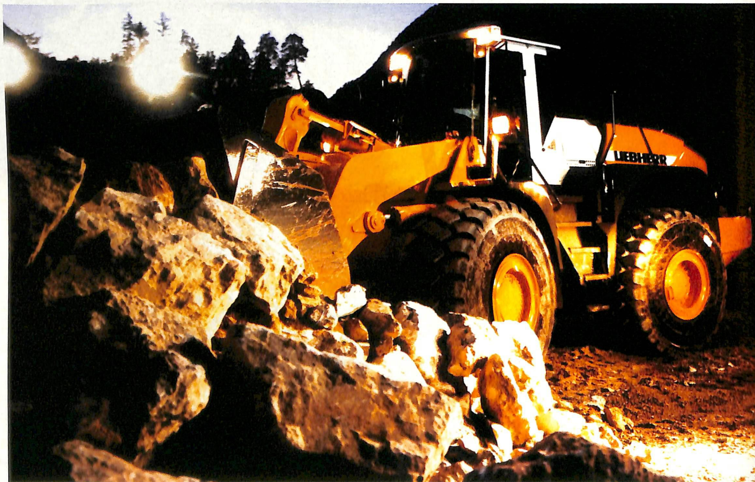
Pá carregadeira L 580: caçamba para 5 m 3 , peso operacional de 24,7 t e motor de 195 kW / 265 HP
