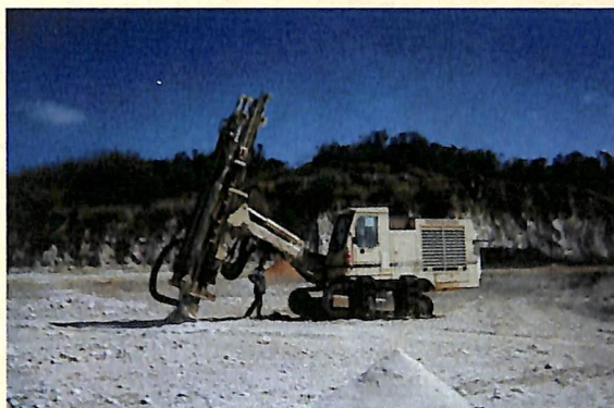
CM-695D em operação na Cimesa: velocidade de perfuração de até 40 m por hora CM-695D en operación en Cimesa: velocidad de perforación de hasta 40 m/h.
