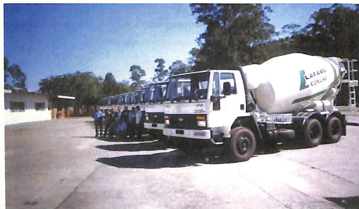
Betoneiras Liebherr com balões de 8 m 3 Hormigoneras Liebherr con balones de 8 m 3
