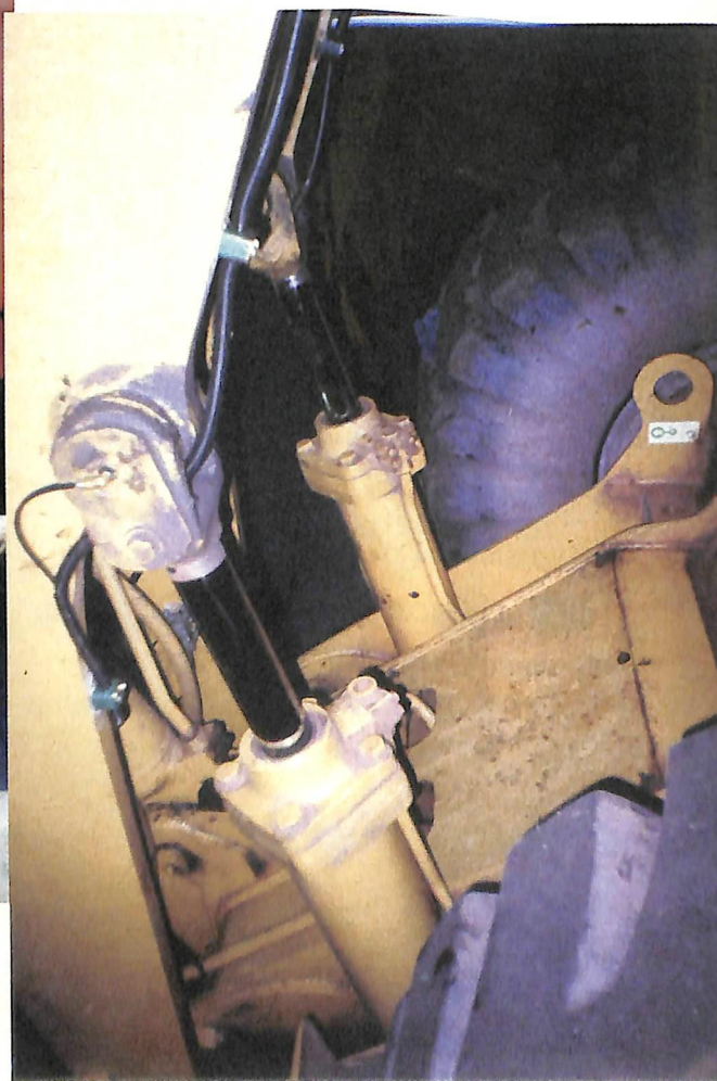
Dosificação constante e certa de graxa nos vários pontos de fricção. Dosificación constante y cierta de grasa en los varios puntos de fricción.
