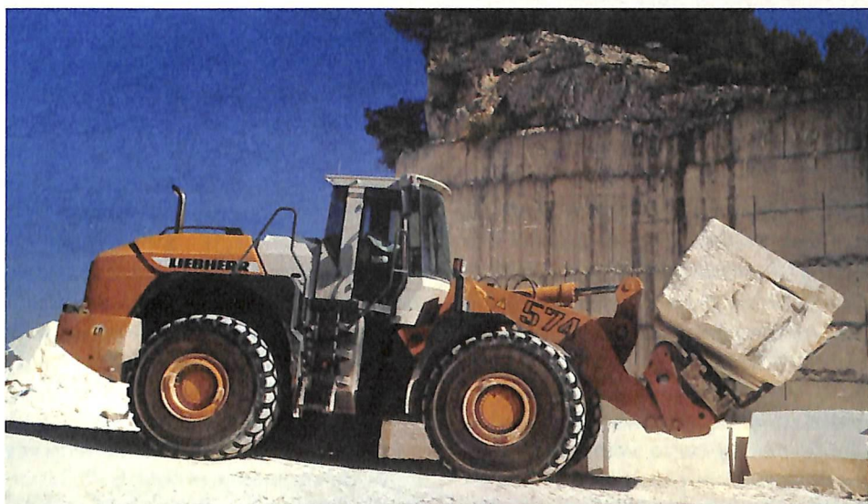
Liebherr 574: transmissão hidrostática Liebherr 574: transmisión hidrostática
