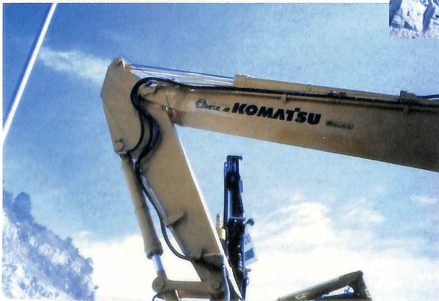
Lubrificação é efetuada com o equipamento ou veículo em movimento. Lubricación es efectuada con el equipo o vehículo en movimiento.
