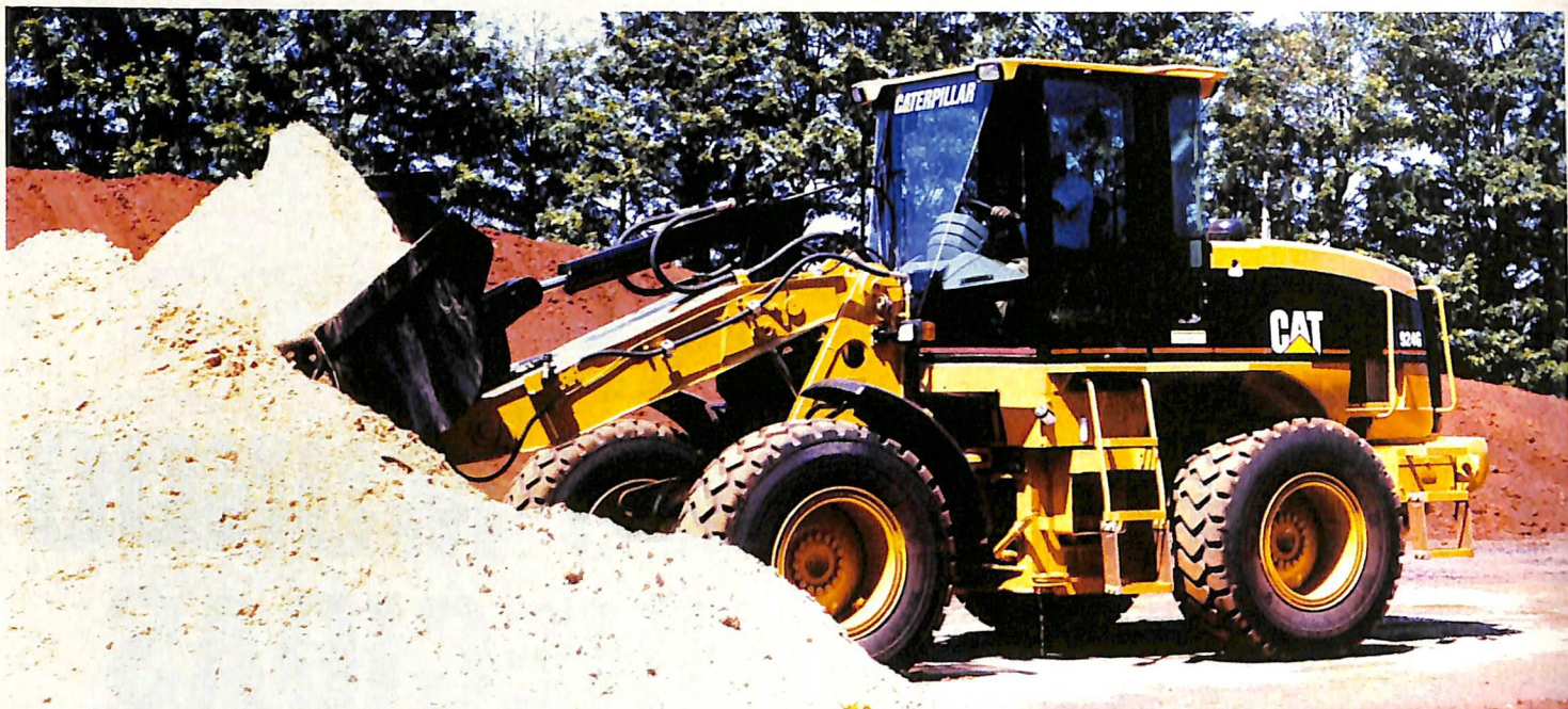
924G: equipada com conjunto frontal Versalink, com projeto de seção em caixa e braço de elevação estilo "lança de escavadeira" 924G: equipado con el varillaje de carga Versalink, con diseño de sección en cajón y brazo de levantamiento tipo pluma de una pieza
