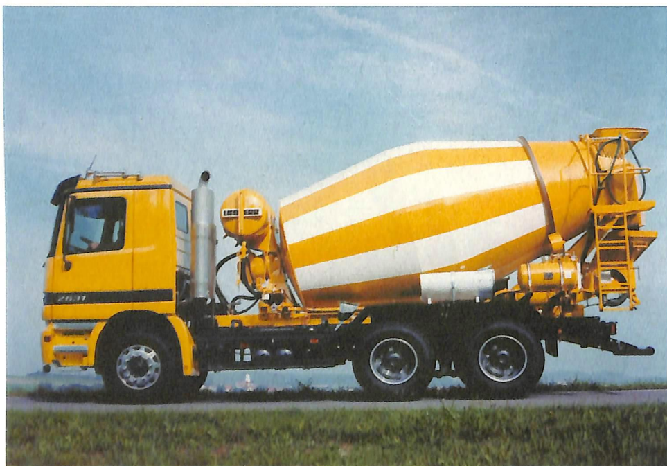
Betoneira Liebherr HTM 704 sobre chassi MB 2423B
