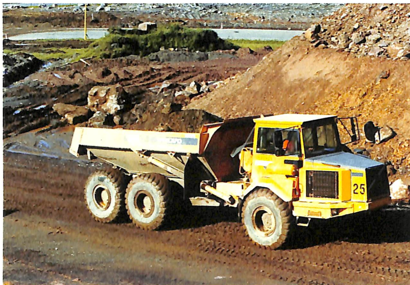
Tração nos três eixos para superar rampas de até 20%
