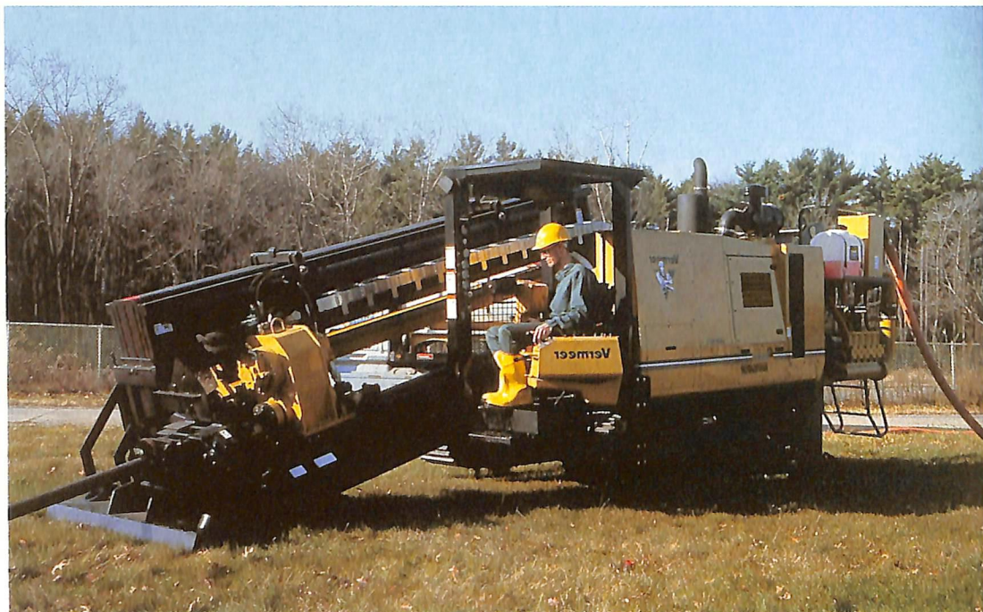
D80 x 100: perfuratriz horizontal direcional da série Navigator, da Vermeer
