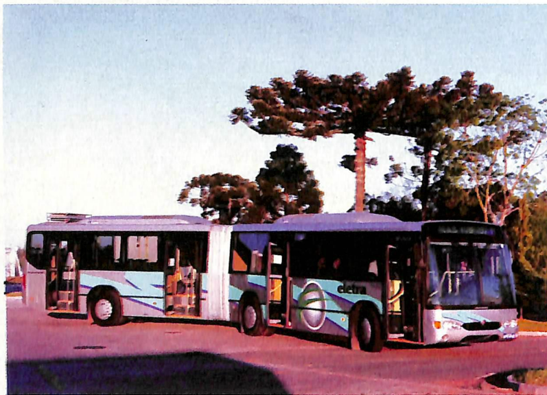
Eletra 2000, primeiro ônibus nacional a combinar motor diesel e elétrico
