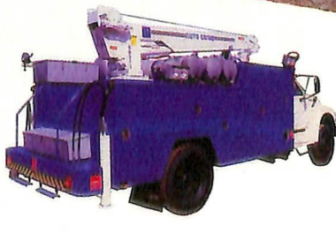
SOS Guindaste. Equipamento de socorro e manutenção de frentes mecanizadas conjugando carro-oficina, almoxarifado e guindaste telescópico.
