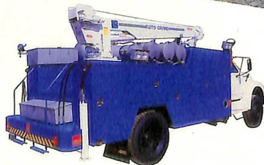
SOS Guindaste. Equipamento de socorro e manutenção de frentes mecanizadas conjugando carro-oficina, almoxarifado e guindaste telescópico.
