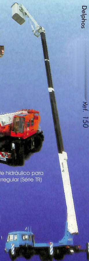
Cesto aéreo isolado para operação em rede elétrica (Série AT)
