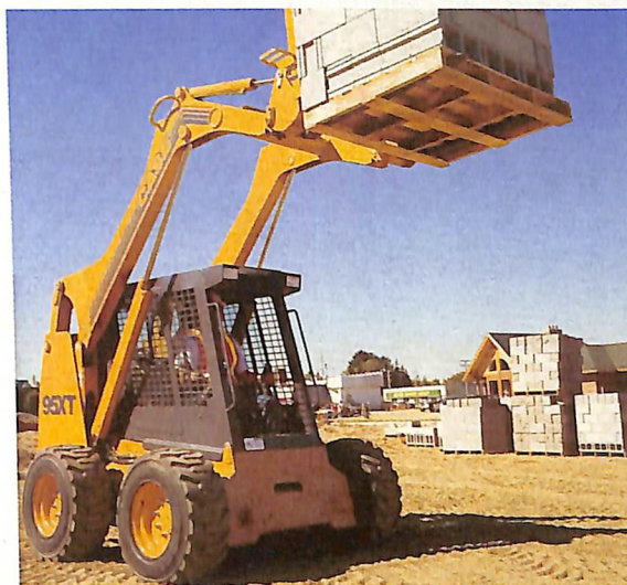
Compactas e resistentes podem suportar cargas de até 900 quilos Compactos y resistentes soportan cargas de hasta 900 kilos
