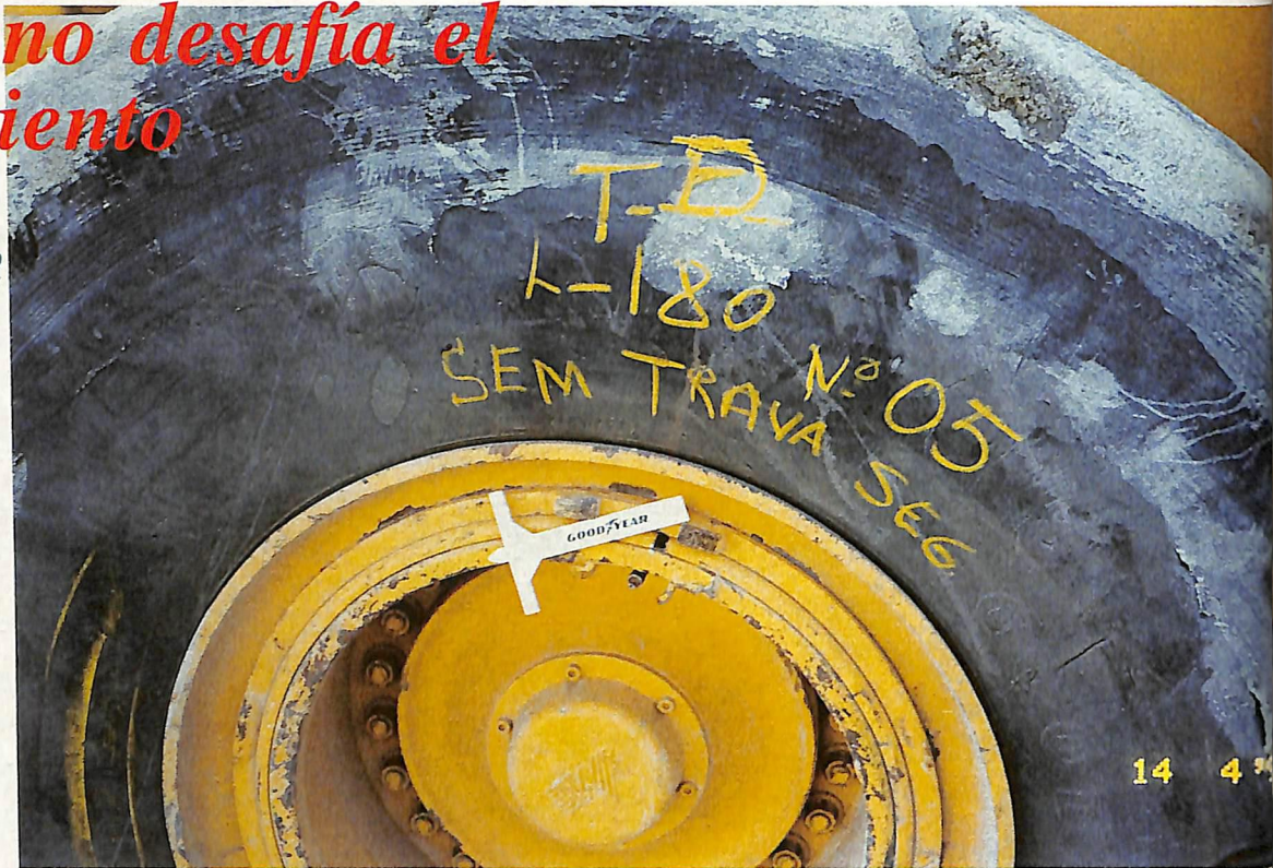
Falta de traba no aro: risco de acidente ou "giro em falso"
