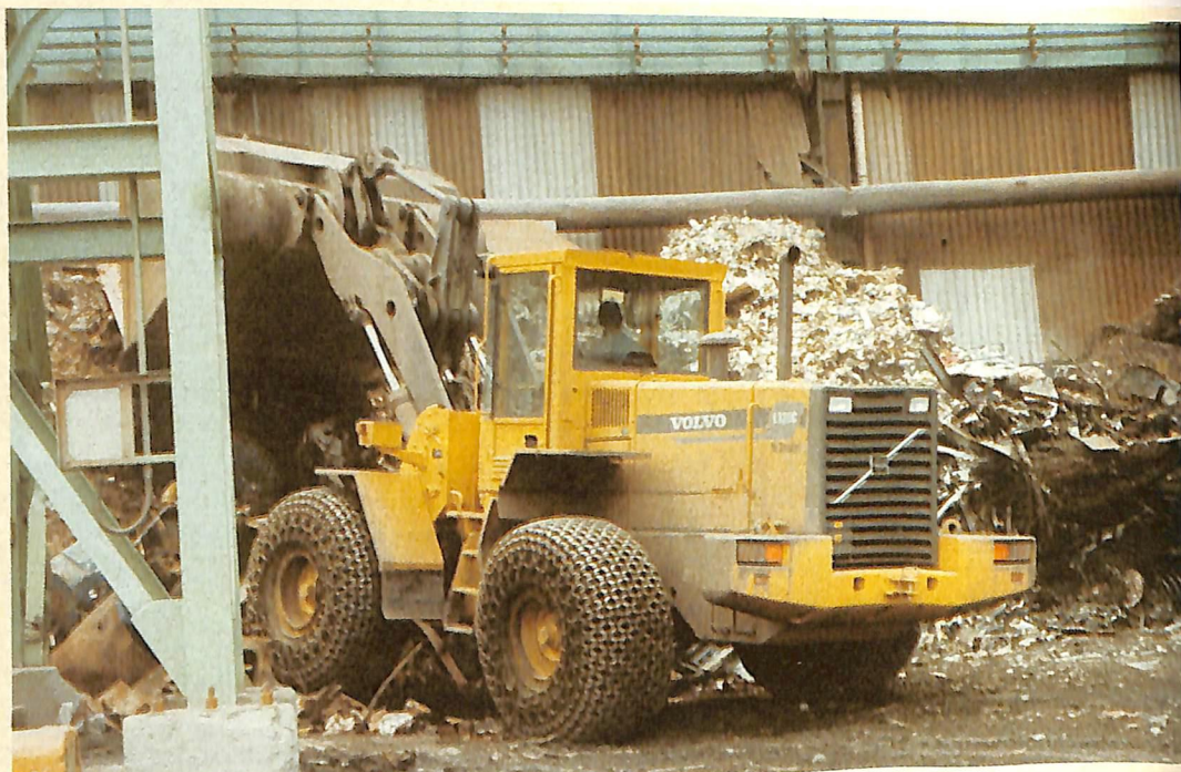
Proteção nas quatro rodas: segurança reforçada
