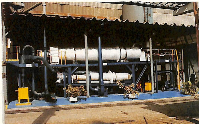
Regenerador Térmico de Areia de Fundição, desenvolvido pela Svedala Faço
