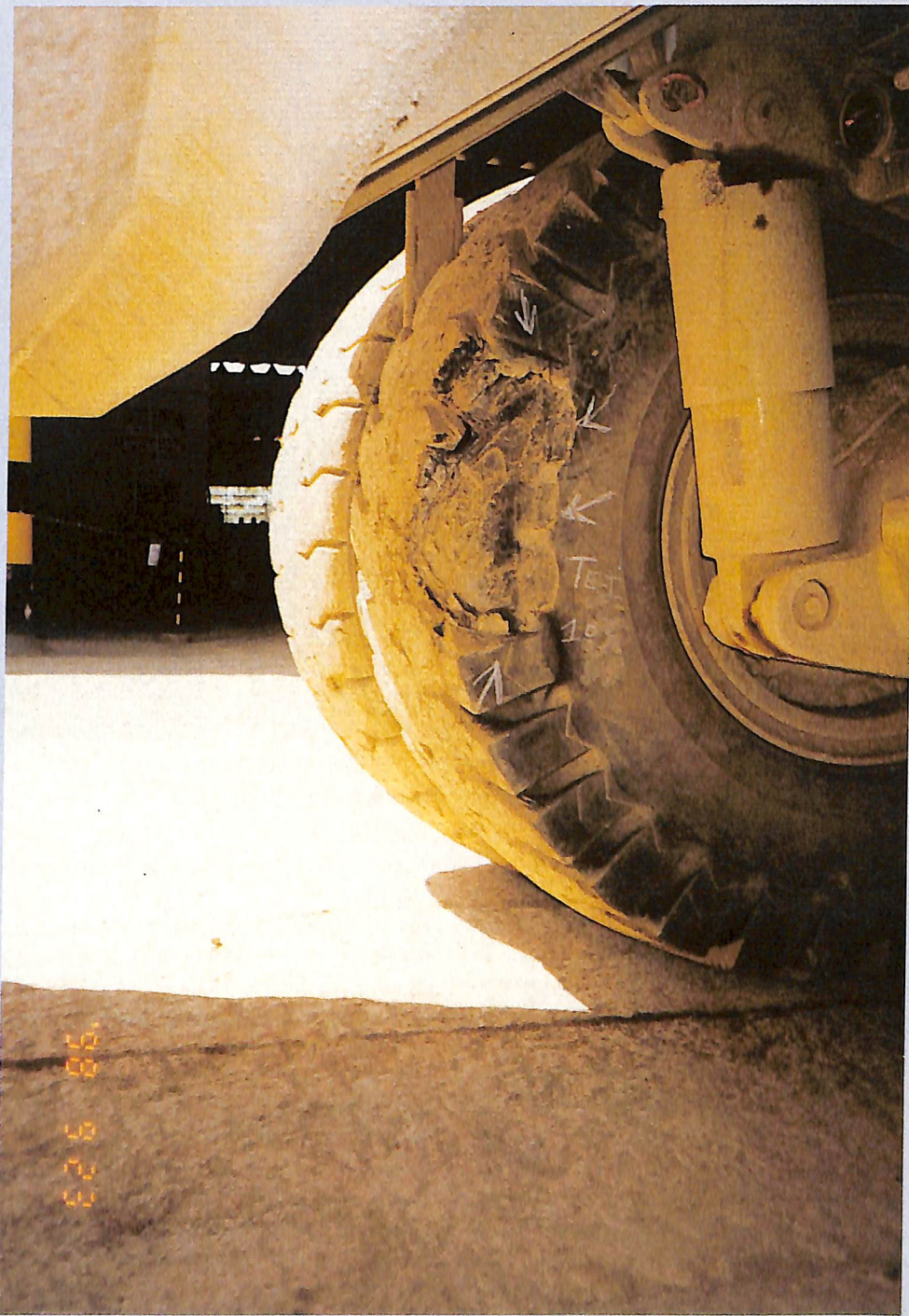
Arrancamento grave no ombro:má conservação de pistas
