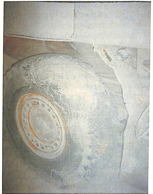
Pneus com TECFLEX utilizados num Shuttle Car JOY da CVRD em Rosário do Catete-SE. Mesmo com grandes rasgos continuam rodando.
