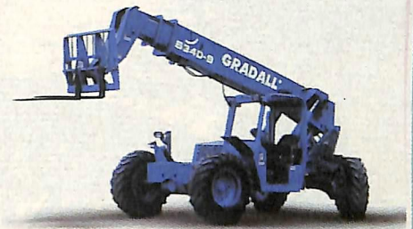
Telemanipulador de materiais: estabilidade em terrenos acidentados
