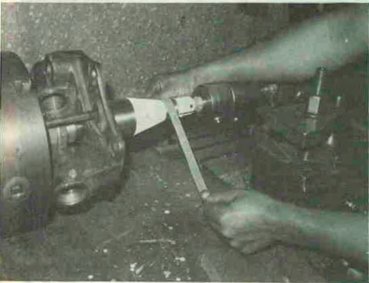
Lixar as arestas da rêsca evitando formas ponteagudas e limpeza c/escova de aço. - fig. 06
