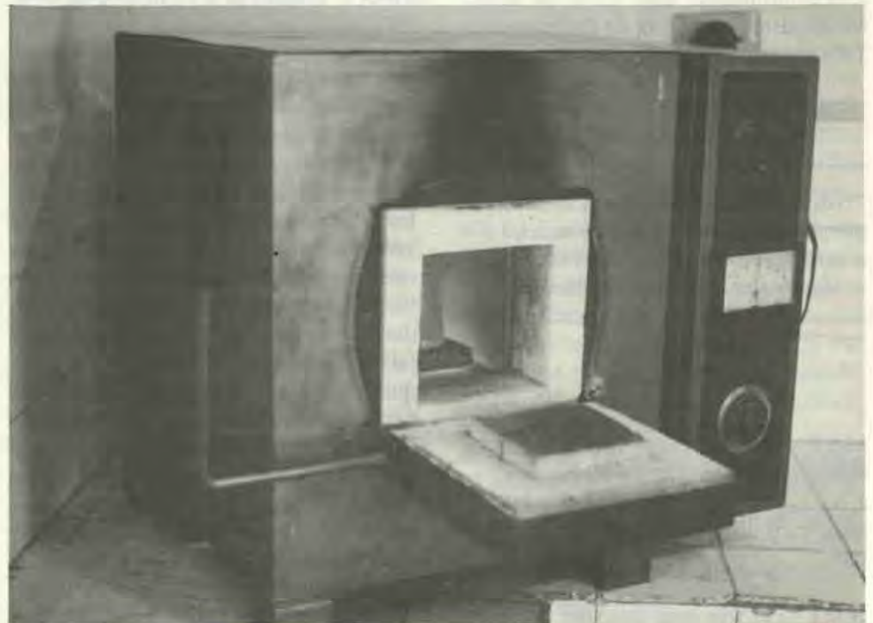
Forno para calcinação, também utilizado em análise de óleos lubrificantes
