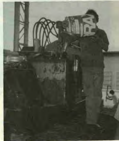
A reposição do óleo hidráulico deve ser efetuada com a máxima limpeza, mesmo em situações adversas.
