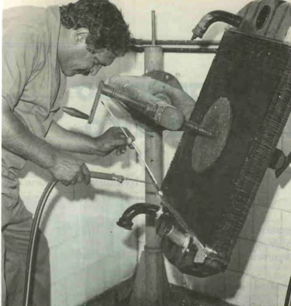
Posicionamento correto da peça recuperada propicia melhor soldagem
