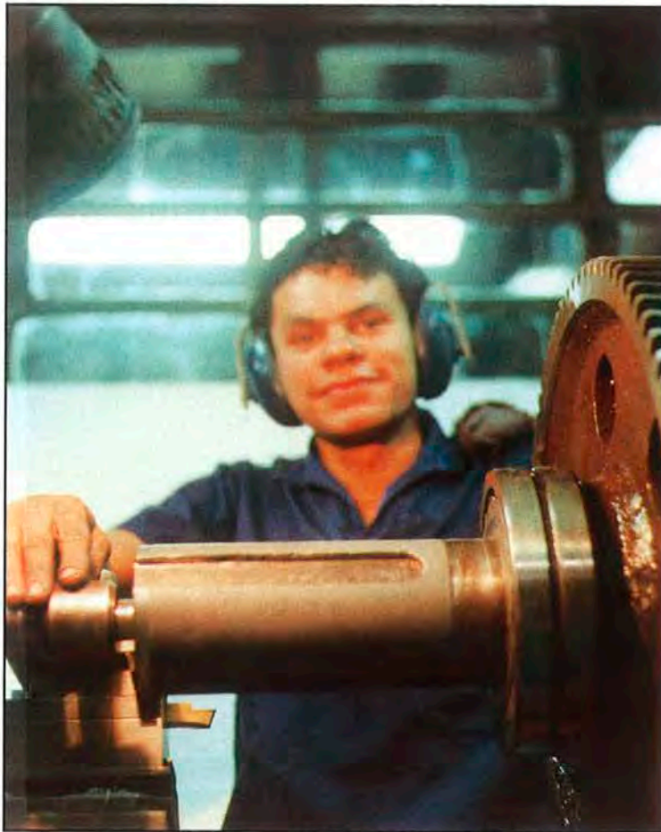
Eixo acabado com detalhe do rasgo de chaveta Eje terminado con detalle de la ranura de chaveta
