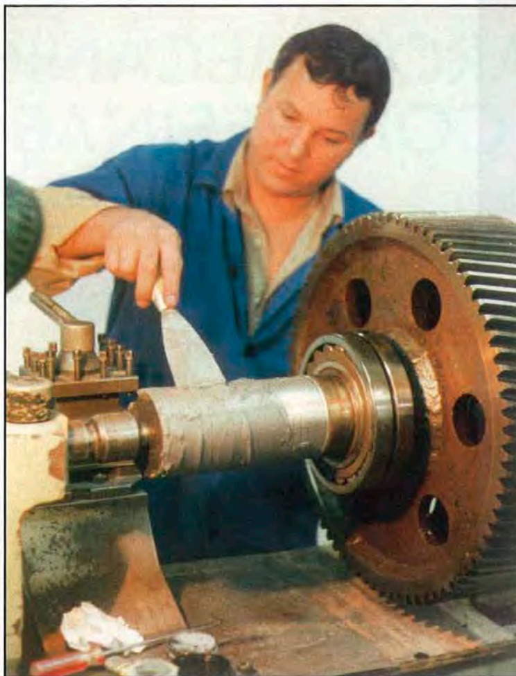
Limpeza química, com Devcon Cleaner e aplicação do Devcon Titâneo
