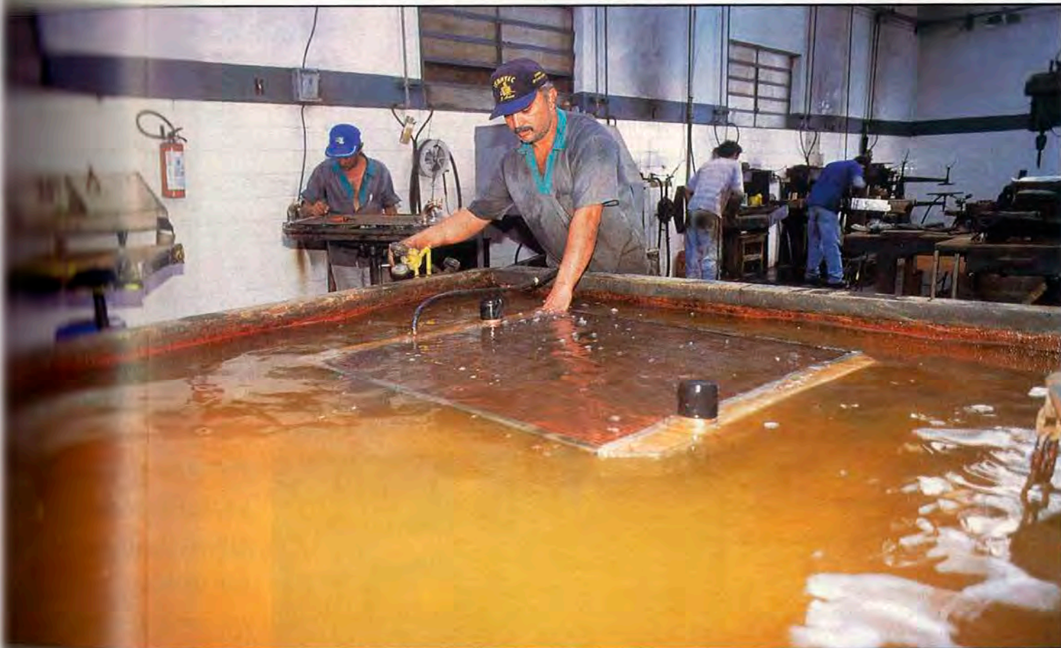
Avaliação da "colmeia" é visual e o teste de vazão da tubulação é feito com água sob pressão.
