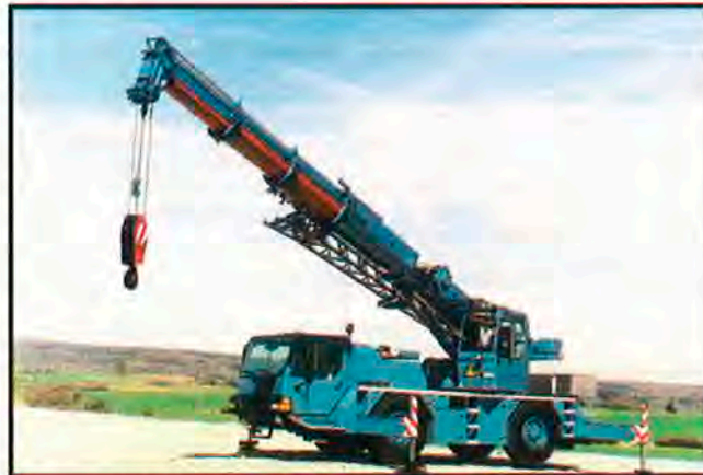
LTM 1030/2: primeiro guindaste móvel com a tecnologia Databus.
