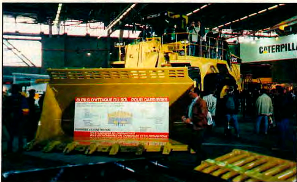
CAT 992G: pá-carregadeira de 92 toneladas.
