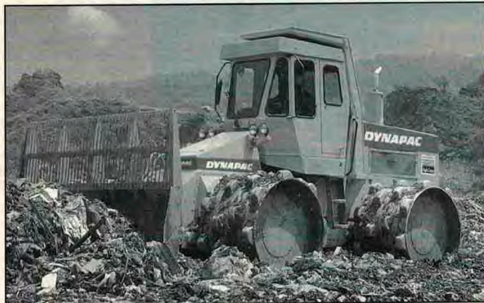
CR25: rodas de aço com três opções de patas
