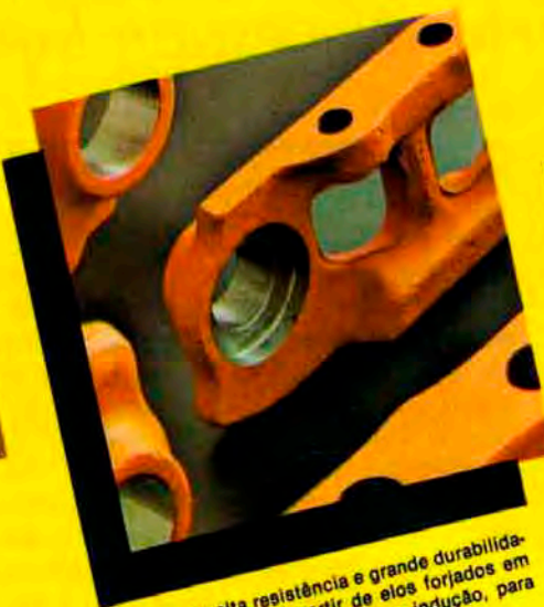
Esteira lubrificada: uma película de óleo é mantida constantemente entre o pino e a bucha, tornando o desgaste entre ambos, praticamente nulo.
