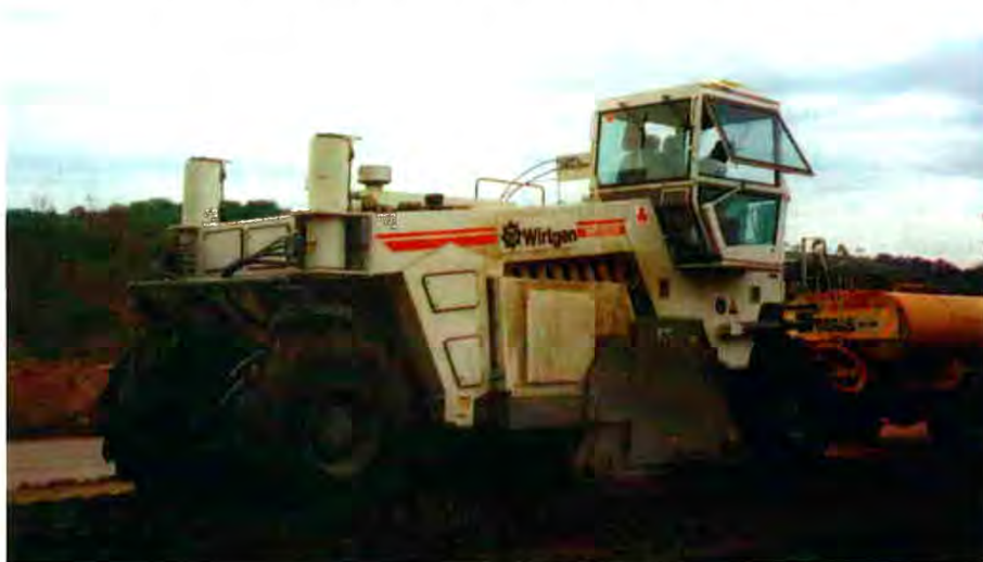
Recicladora de pavimento asfáltico WR 2500, da Wirtgen, a única em operação no Brasil
