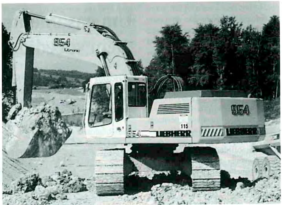
Escavadeira Hidráulica/Eletrônica LIEBHERR R954 Litronic, equipada com motor Diesel LIEBHERR D 926 TI.
