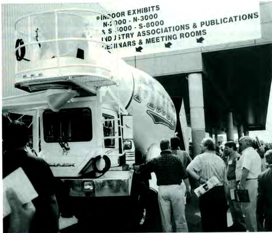
Caminhão betoneira com cabine na traseira.
