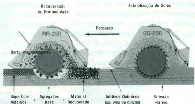
Rotor e câmara de mistura da recuperadora de rodovias controlam a profundidade, tamanho apropriado e mistura uniforme dos materiais.
