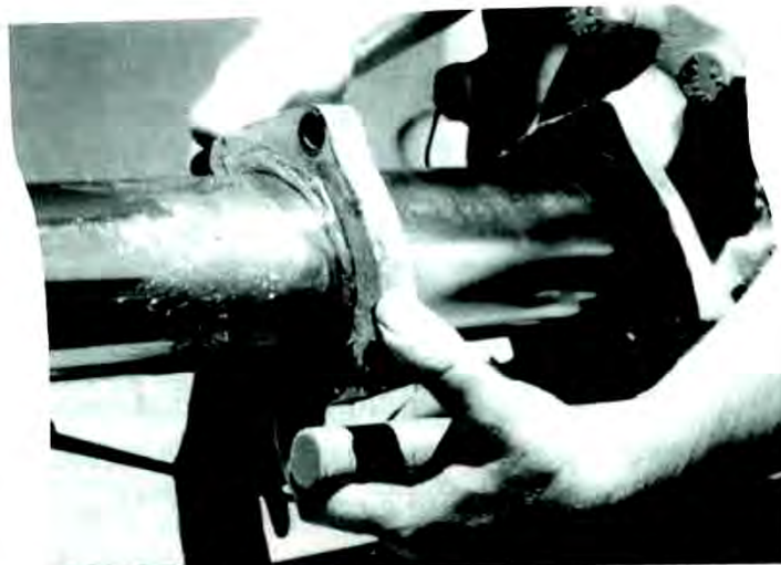
Verificação da condição do anel-raspador. Recomenda-se passar vaselina ou graxa na haste ao deslizar o anel.
