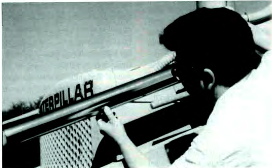
Inspecção da haste do cilindro, a fim de detectar riscos, lascamentos ou mossas.
