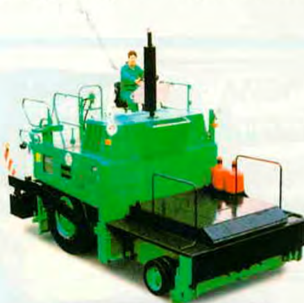
Pavimentadora de asfalto
