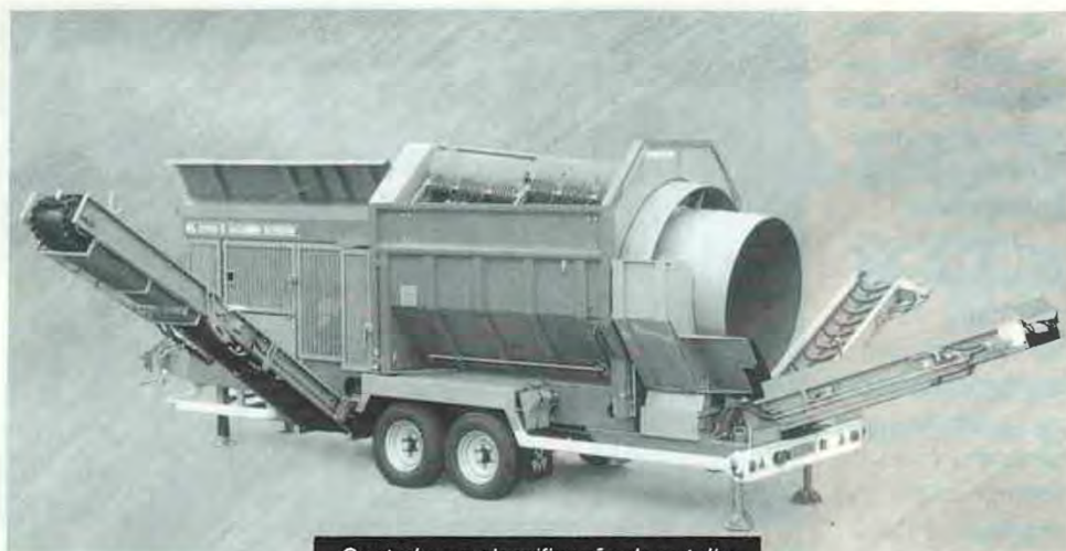
Central para classificação de entulho e material vegetal.
