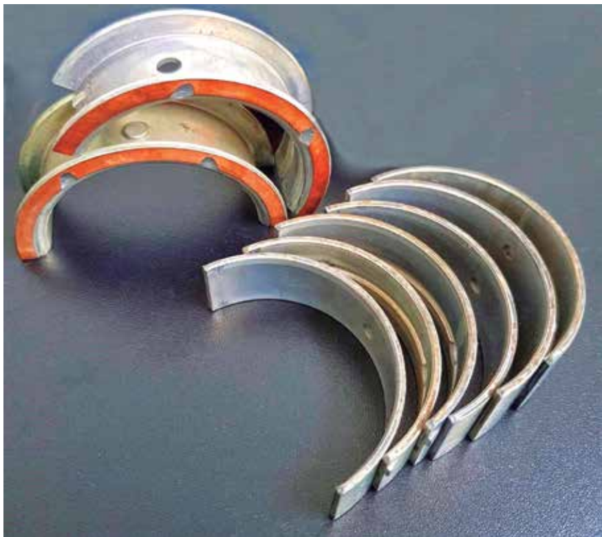
Seleção da bronzina deve considerar o tipo de motor e o material de fabricação
