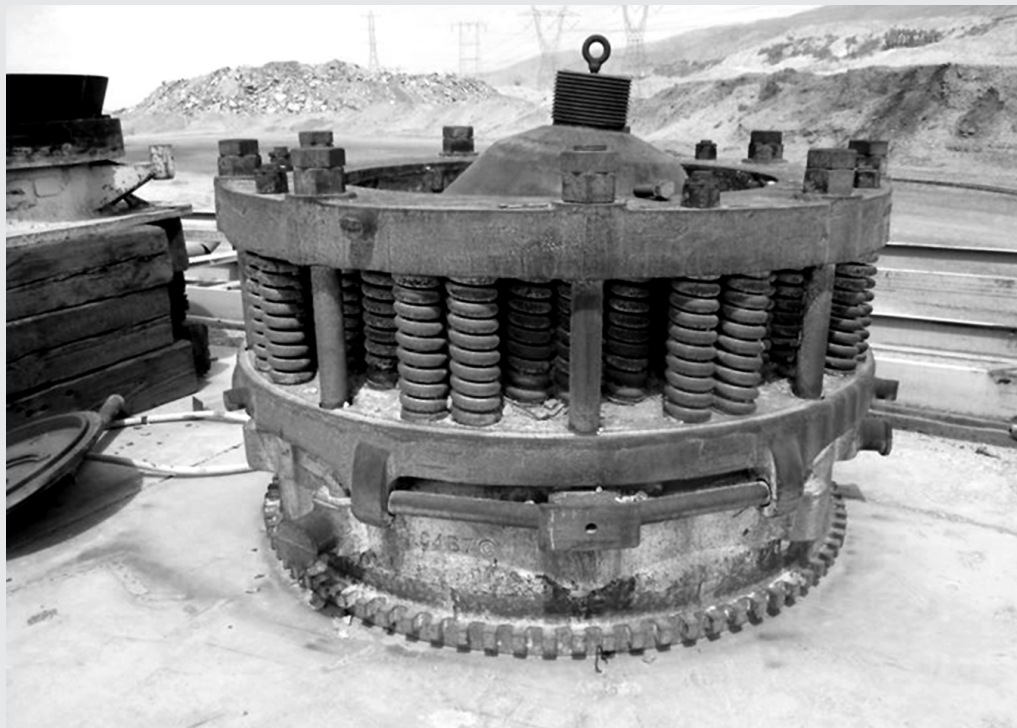
O gyrasphere foi um projeto giratório de perfil alternativo desenvolvido pela Pegson-Telsmith nos anos 50
