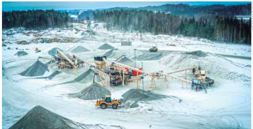
Linha NW Rapid é composta por britadores e peneiras na faixa de 250 t/h de capacidade
