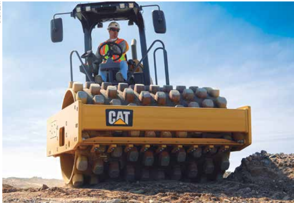
Especialistas explicam que o tambor com kit patas apresenta perda de desempenho quando comparado a um compactador pé de carneiro original
