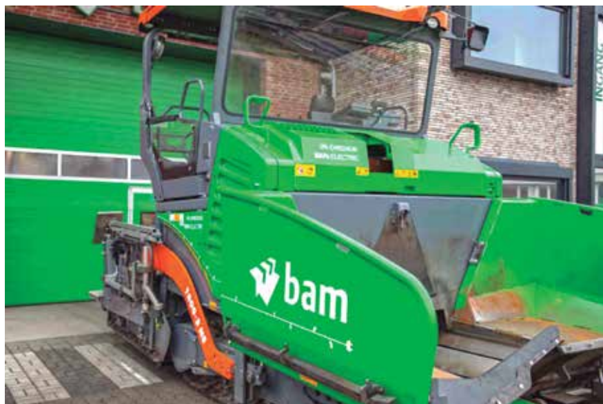
Sistema de acionamento é composto por bateria de 270 kWh e dois motores elétricos
