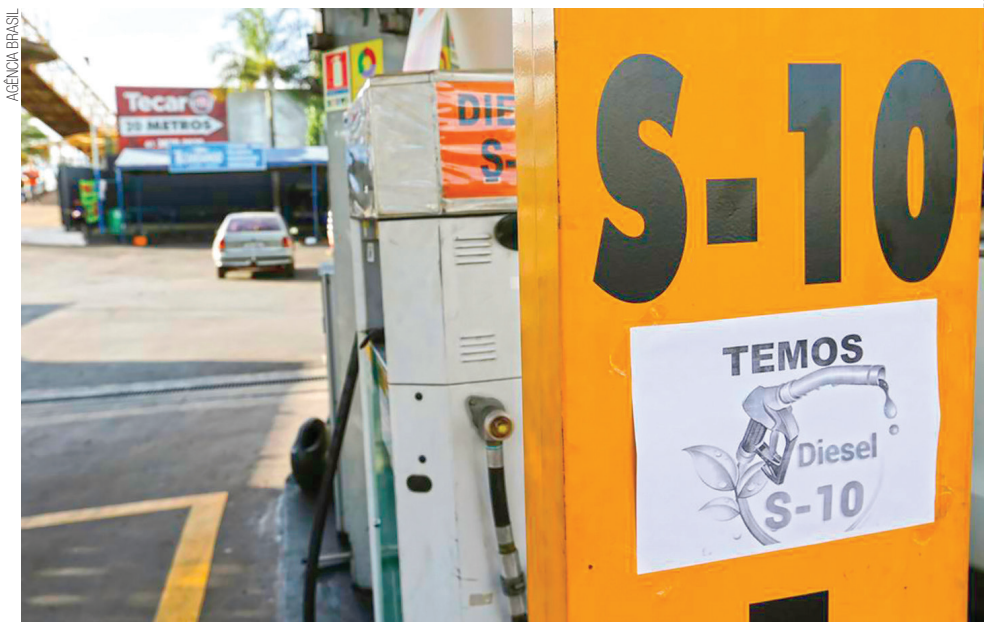
Nos últimos anos, o diesel vem tendo seu teor de enxofre substancialmente reduzido, chegando a 10 ppm
