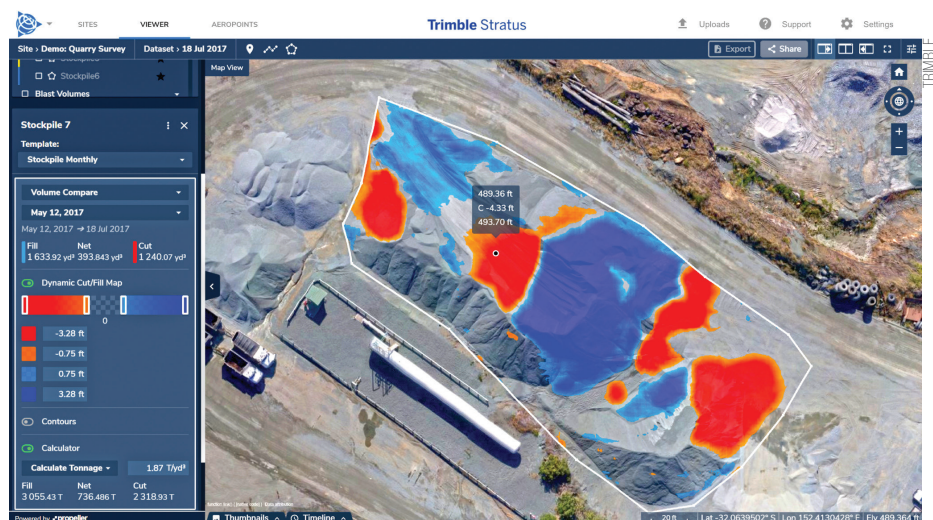
Levantamento topográfico com drones utiliza software de processamento de imagens e extração de informações da nuvem de pontos
