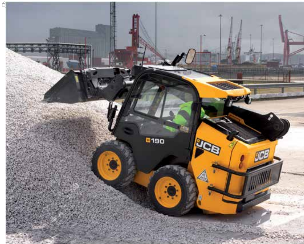
Soluções como minicarregadeiras são dimensionadas pela capacidade de carga e altura de descarga
