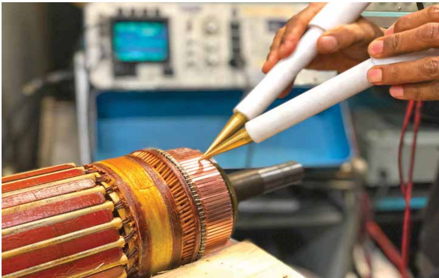
Um dos motivos para se medir tensão e corrente é averiguar eventual desequilíbrio no motor
