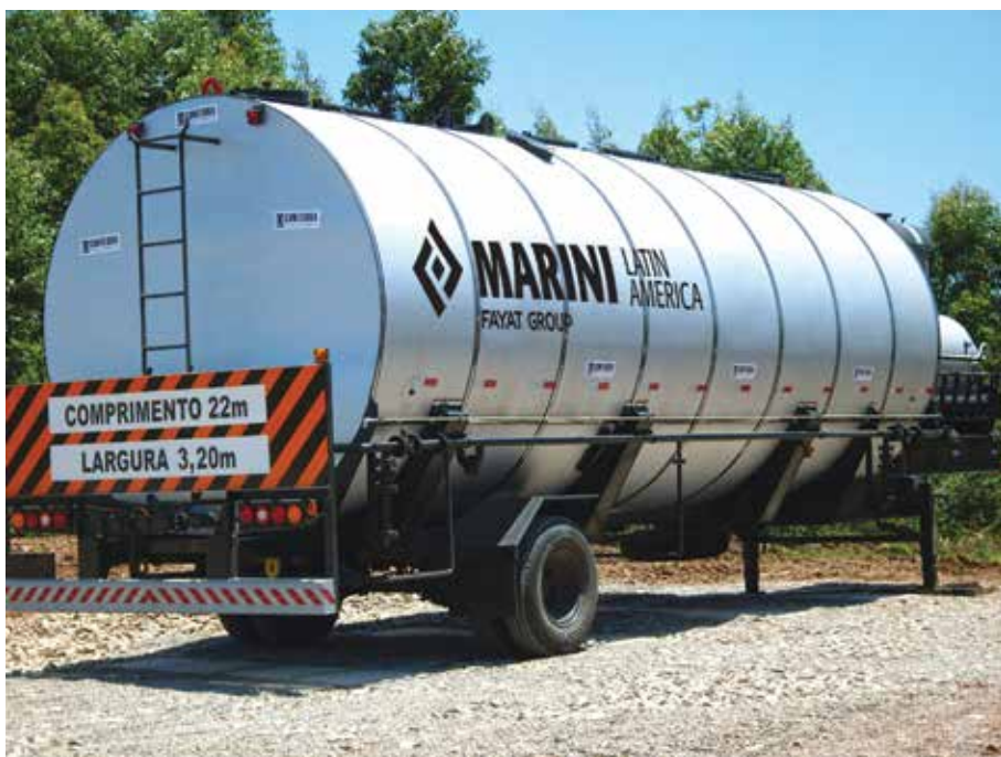
Tanques de armazenamento mantêm a temperatura e as propriedades do asfalto
