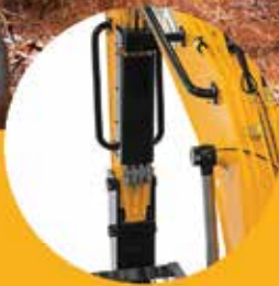
PREPARAÇÃO PLUG AND PLAY PARA CABEÇOTE HARVESTER, LINHAS HIDRÁULICAS DE ALTO FLUXO
