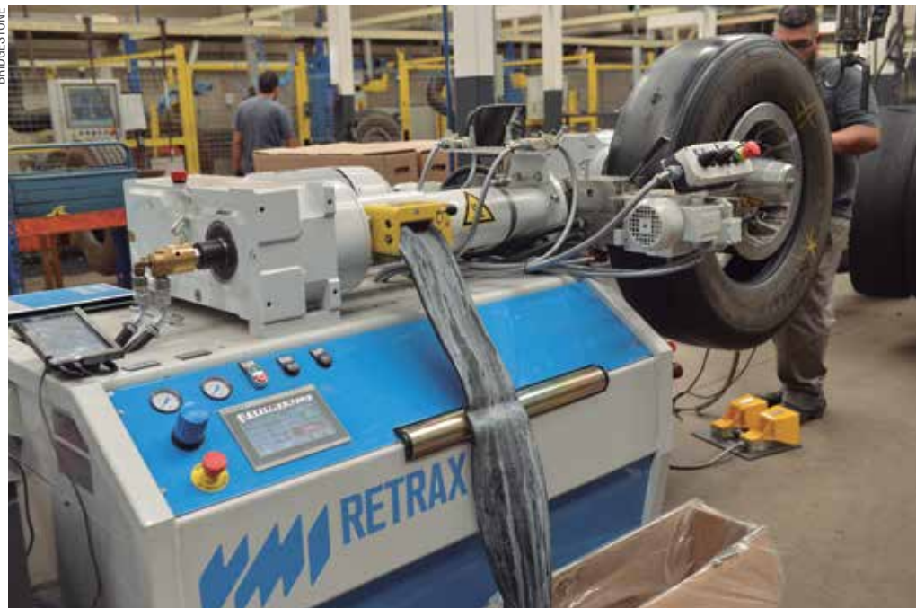
Processo de reconstrução inclui avaliação detalhada da carcaça
