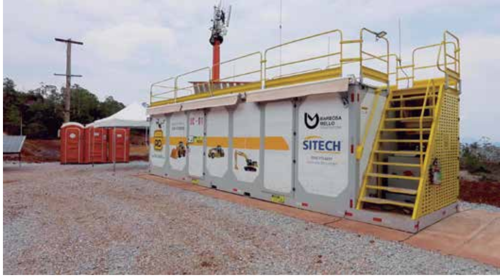
Central monitora a atividade por meio de câmeras instaladas em pontos estratégicos do equipamento e no local de operação
