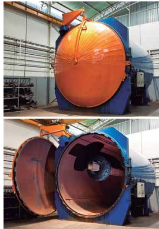
Pneus OTR maiores exigem autoclaves de grande porte na vulcanização
