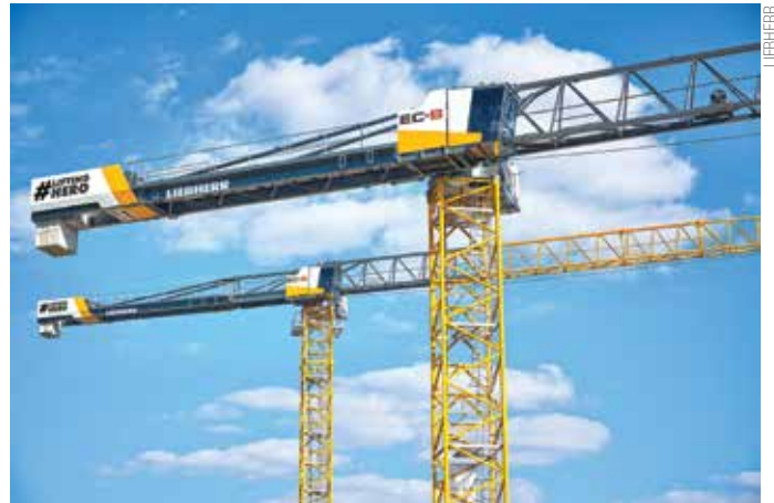
A Liebherr apresentou soluções como o guindaste de torre 340 EC-B, incluindo versões com cabo de fibra sintética
