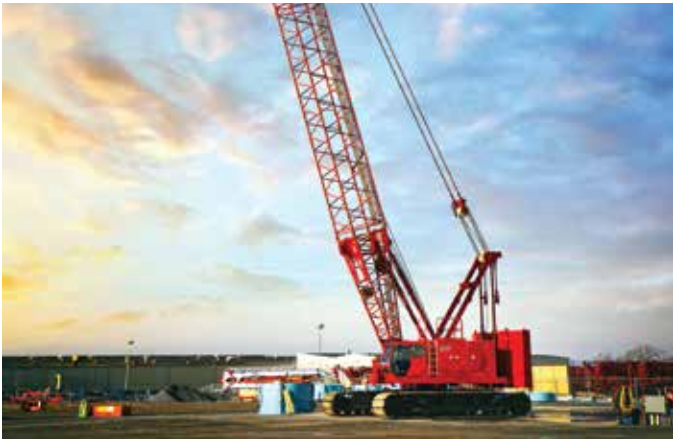
Com capacidade aumentada para 150 t, o guindaste MLC150-1 foi o carro-chefe da Maniowoc
