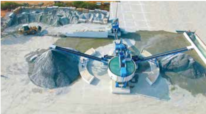
Com atualizações estruturais, o Combo X900 da CDE teve a capacidade ampliada para 500 t/h
