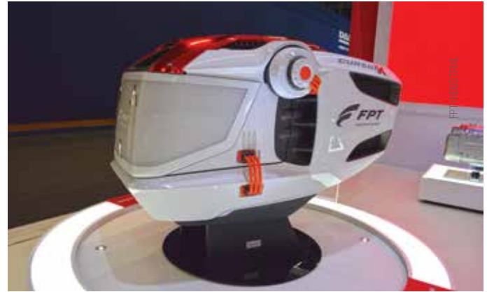
A FPT promoveu o modelo Cursor X , que pode ser alimentado por gás natural, baterias ou células de hidrogênio
