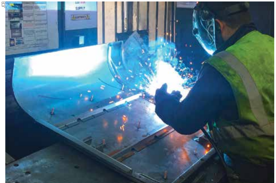
Processo MIG/MAG garante boa penetração, qualidade de acabamento e nível reduzido de respingos
