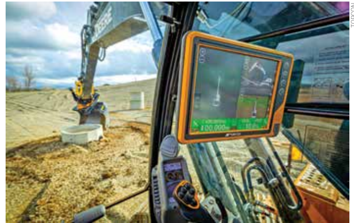
A Topcon desenvolveu a funcionalidade de rotação inclinada para o sistema automático de escavação X-53x
