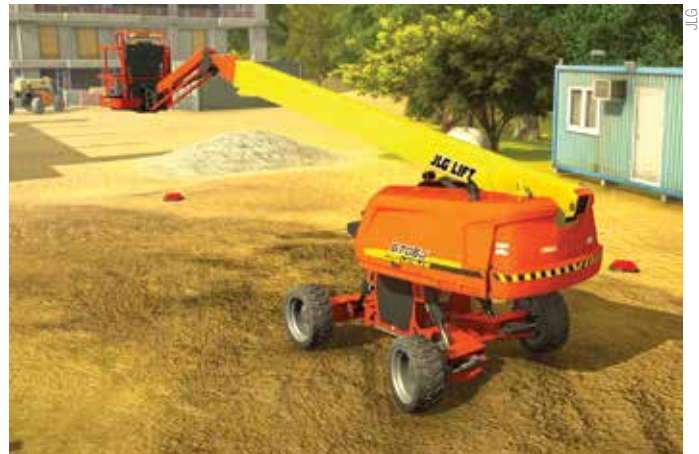
Destaque da JLG, a plataforma de lança autonivelante 670SJ tem alcance de 20,4 m
