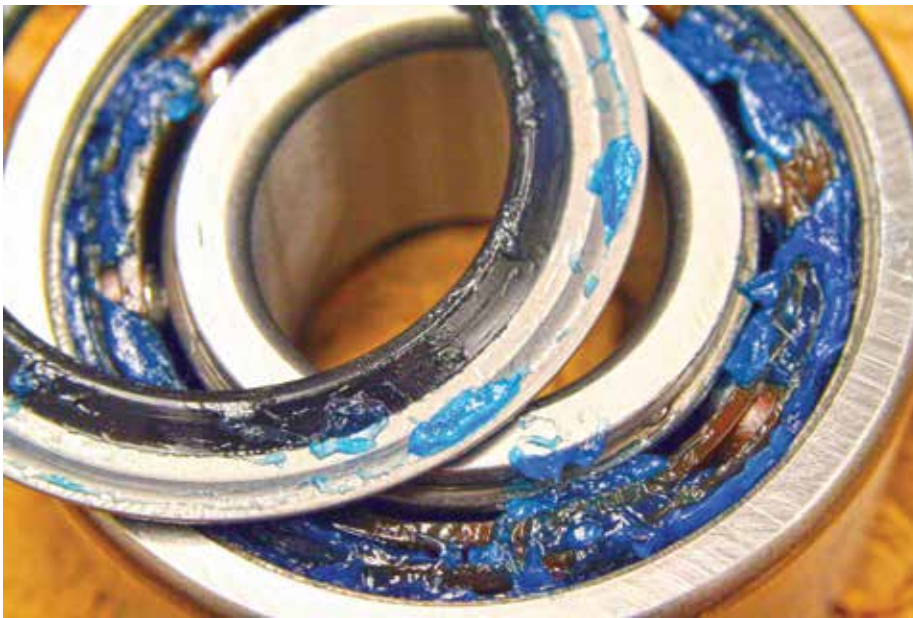
Geralmente, a lubrificação com graxa é utilizada em aplicações de velocidade baixa a moderada
