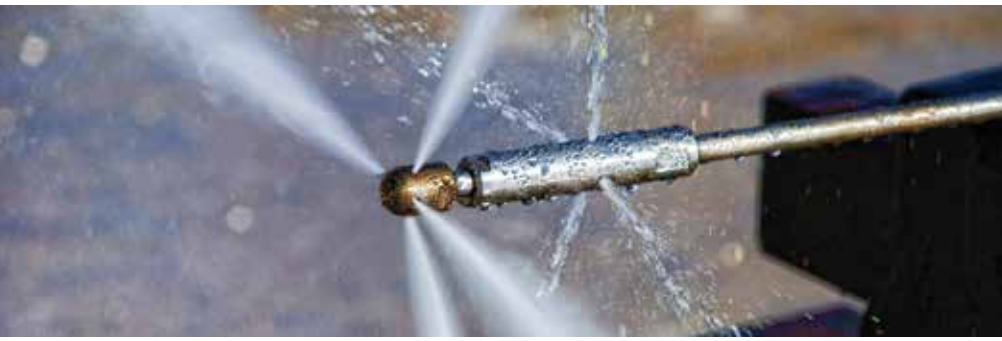
Bombeada em pressões elevadas , a água penetra na estrutura e expulsa o material para o exterior
