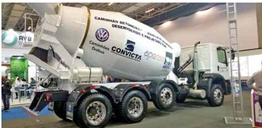
Com capacidade de 8 m 3 , protótipo de caminhão-betoneira da Convicta traz balão de aço inoxidável
