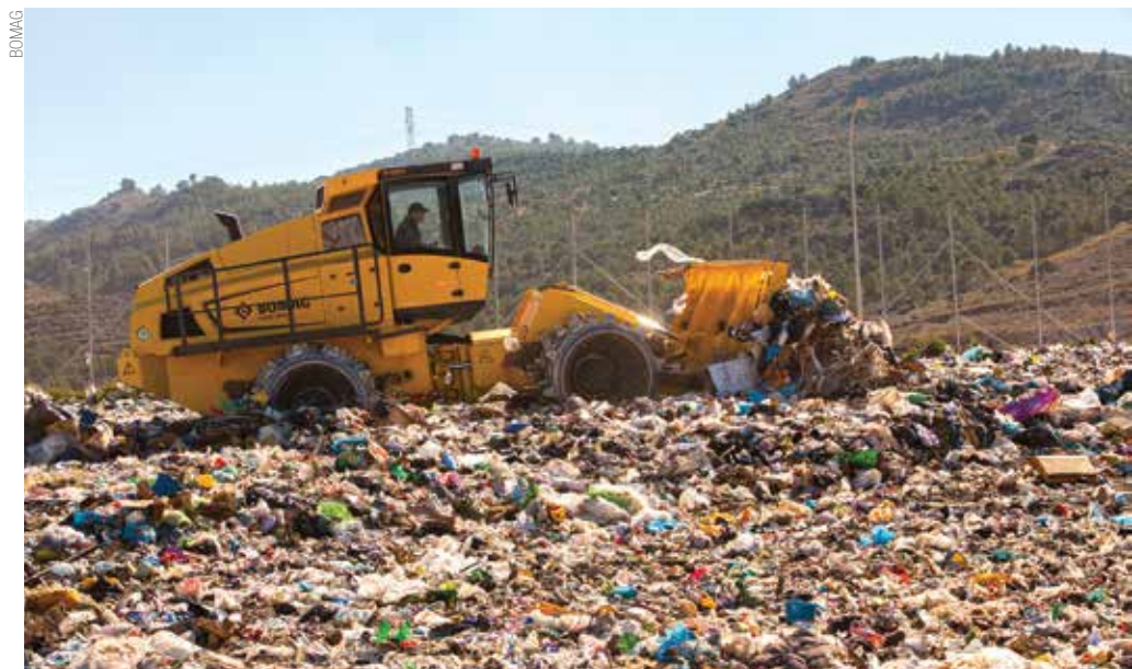
Elevando a densidade dos aterros , os compactadores permitem um maior volume de material no mesmo espaço
