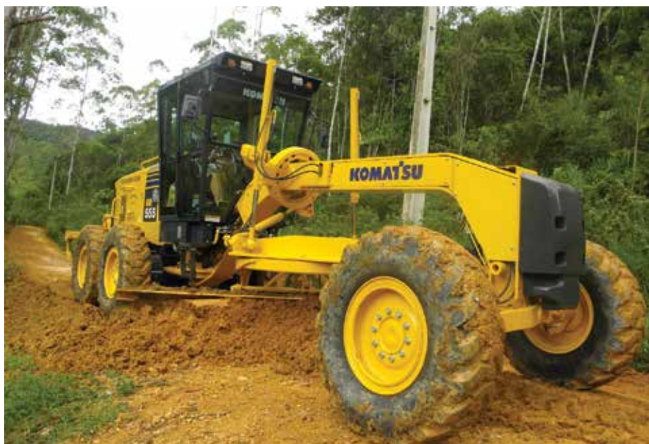
A atenção ao plano de manutenção evita problemas em componentes como coroa, pinhão e mesa do círculo
