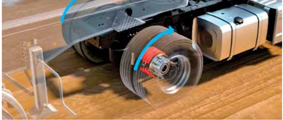
Já itens de série, soluções como o EBS distribui a frenagem de maneira individual para cada roda do veículo
