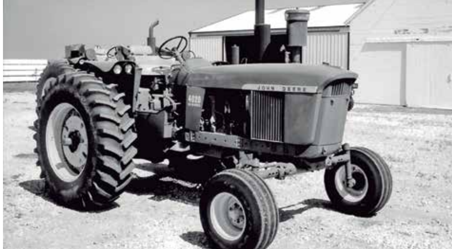
Lançado em 1963 , o John Deere 4020 foi o primeiro case bem-sucedido de trator agrícola com transmissão powershift
