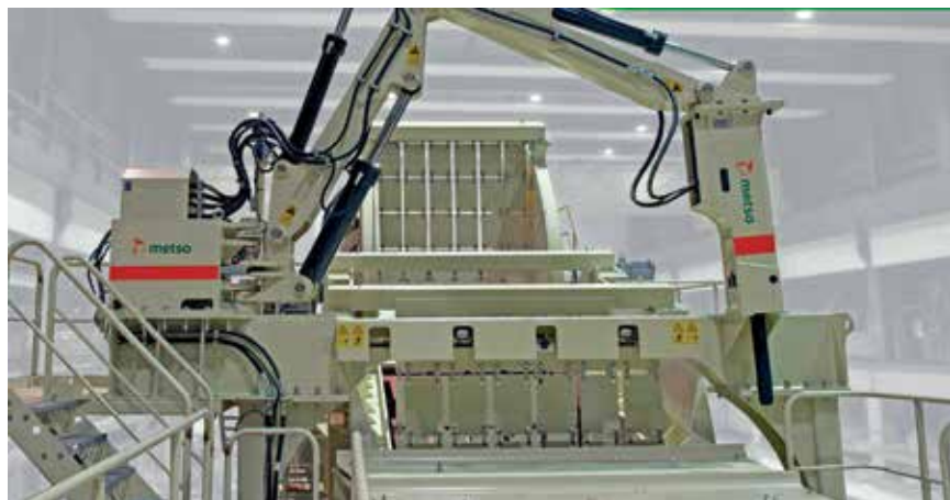
Eficiência do rompedor está em permitir a continuidade do fluxo da britagem
