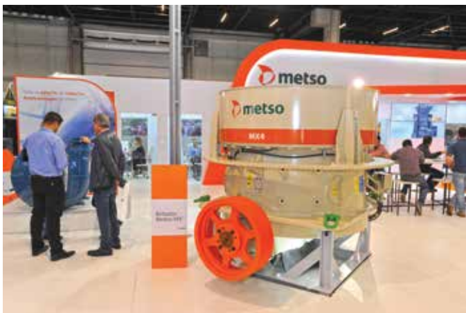
A Metso apresentou a série de britadores cônicos MX, que trabalha com dois princípios de ajustes
