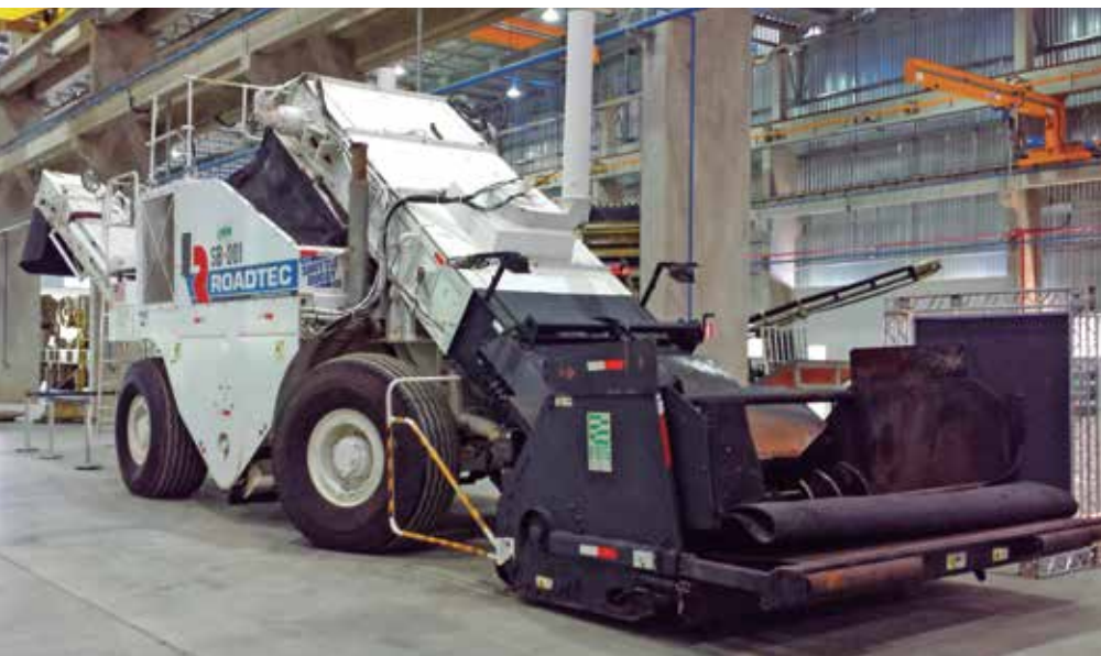
Shuttle buggy: disposição homogeneizada da massa, sem bolsões de asfalto frio
