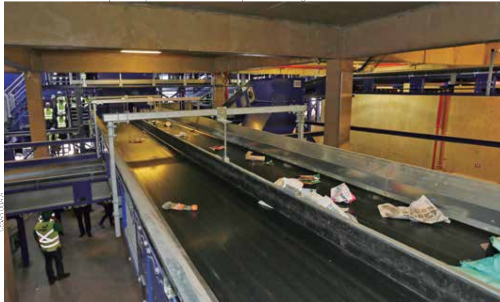
Material reciclável seco percorre quilômetros de esteiras no processo de triagem
