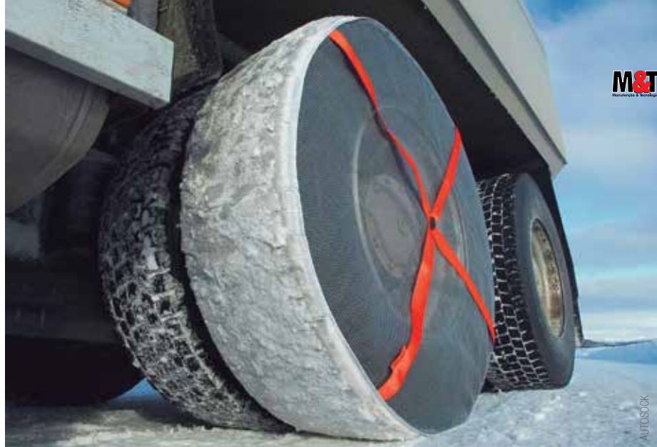
Em 2015, a província de Colúmbia Britânica, no Canadá, aprovou uma nova solução de tração de pneus para uso em rodovias cobertas de neve, as chamadas proteções “meias de neve”. Aprovado em 2011 pela Associação de Inspeção Técnica da Alemanha (TÜV - Technischer Überwachungsverein), o produto de base têxtil da empresa norueguesa AutoSock propõe-se a entregar ainda mais tração que as correntes
