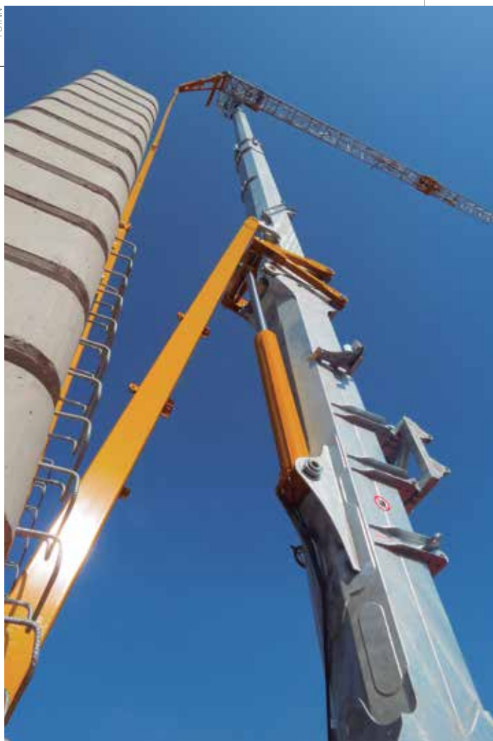
Modelos automontáveis como essa grua Potain Hup 40-30 facilitam o trabalho de preparação para a obra, garantem especialistas
