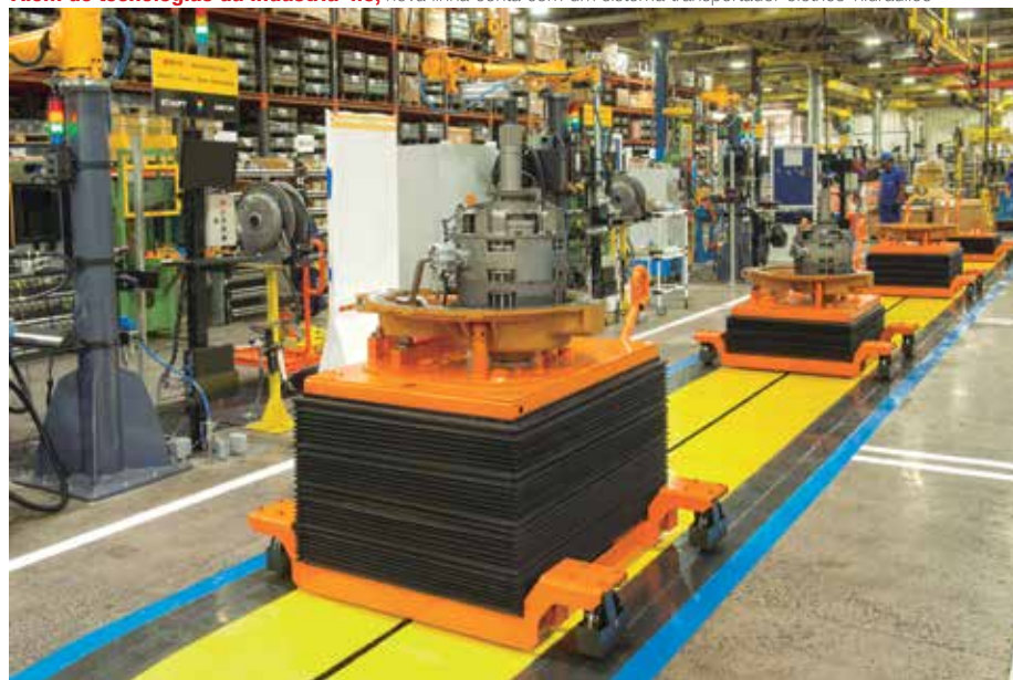
Além de tecnologias da Indústria 4.0, nova linha conta com um sistema transportador elétrico-hidráulico
