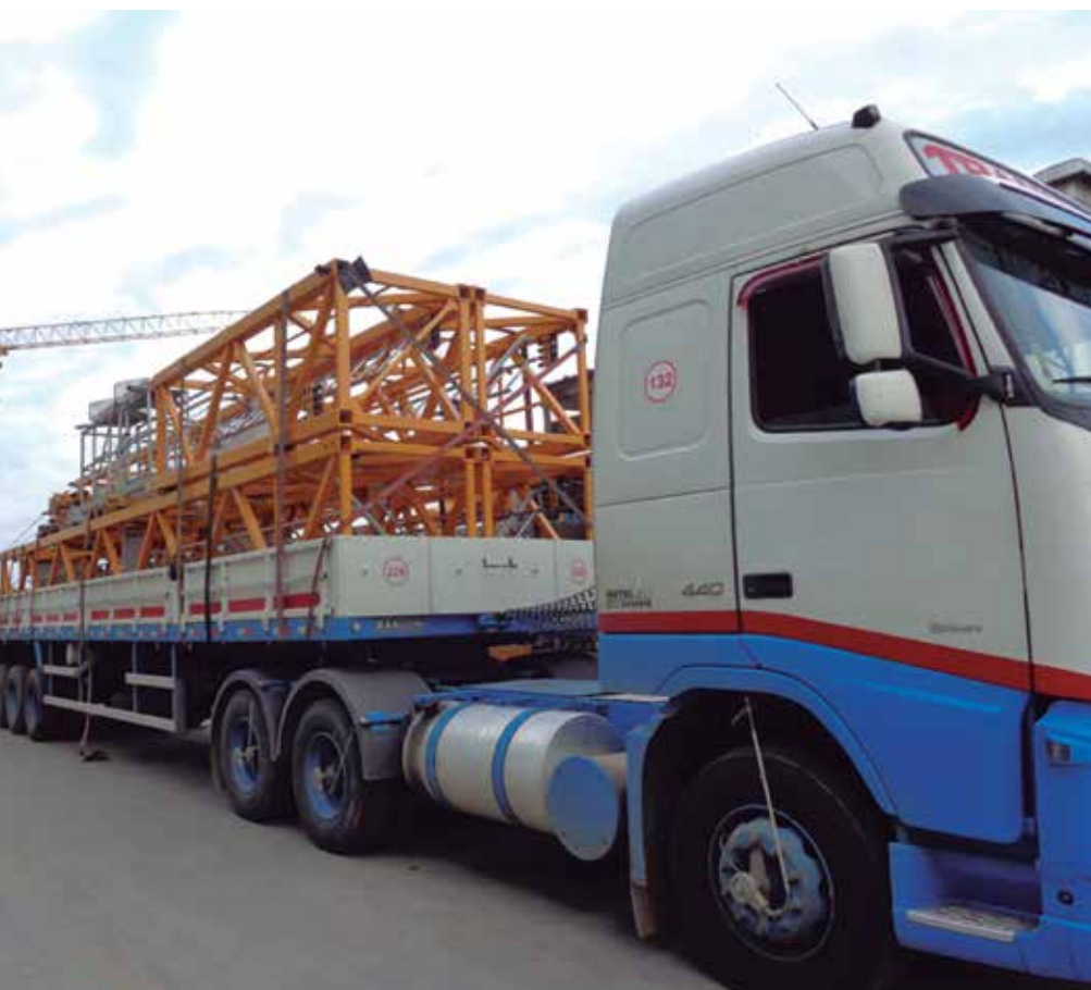
Geralmente, o transporte de guindastes é feito por rodovias em carretas convencionais
