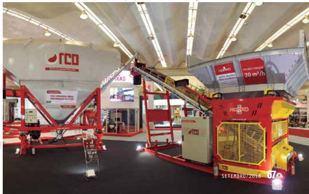
Centrais dosadoras como esta Nomad D-20 apostam na facilidade de instalação nos canteiros
