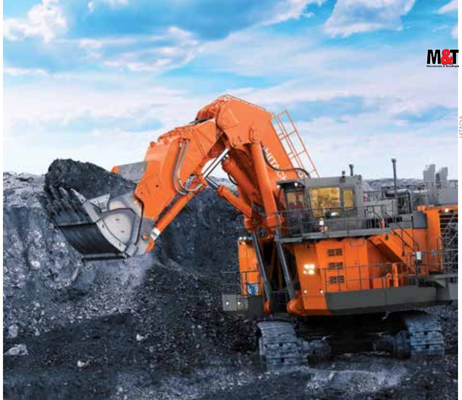
Modelos da Hitachi contam com nivelamento automático, que permite alterar o cinemático do implemento
