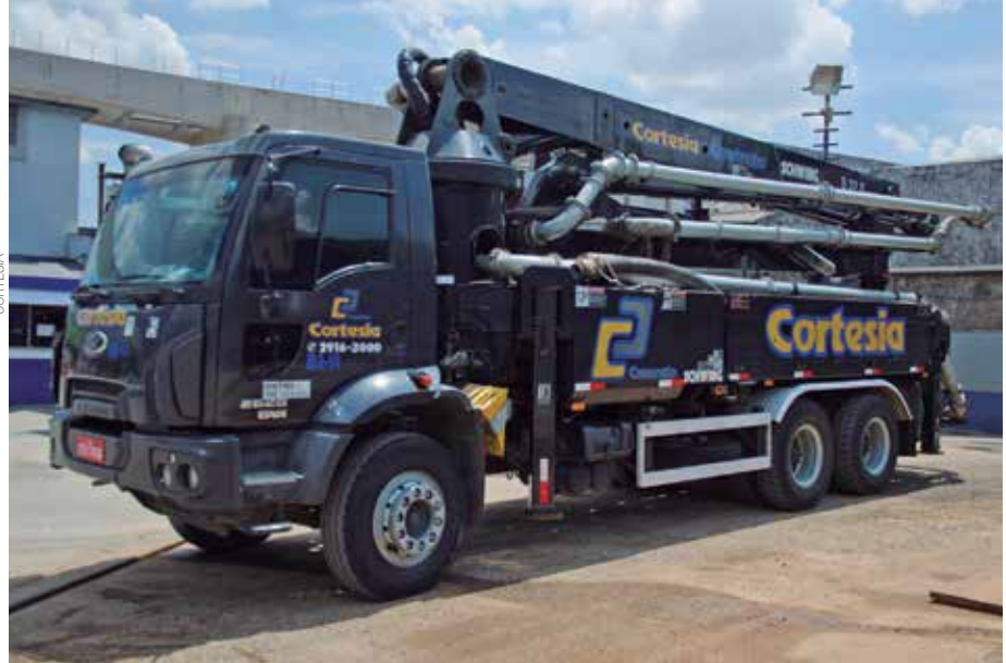
Limpeza deve ser feita após cada concretagem ou em caso de intervalos muito longos entre as descargas
