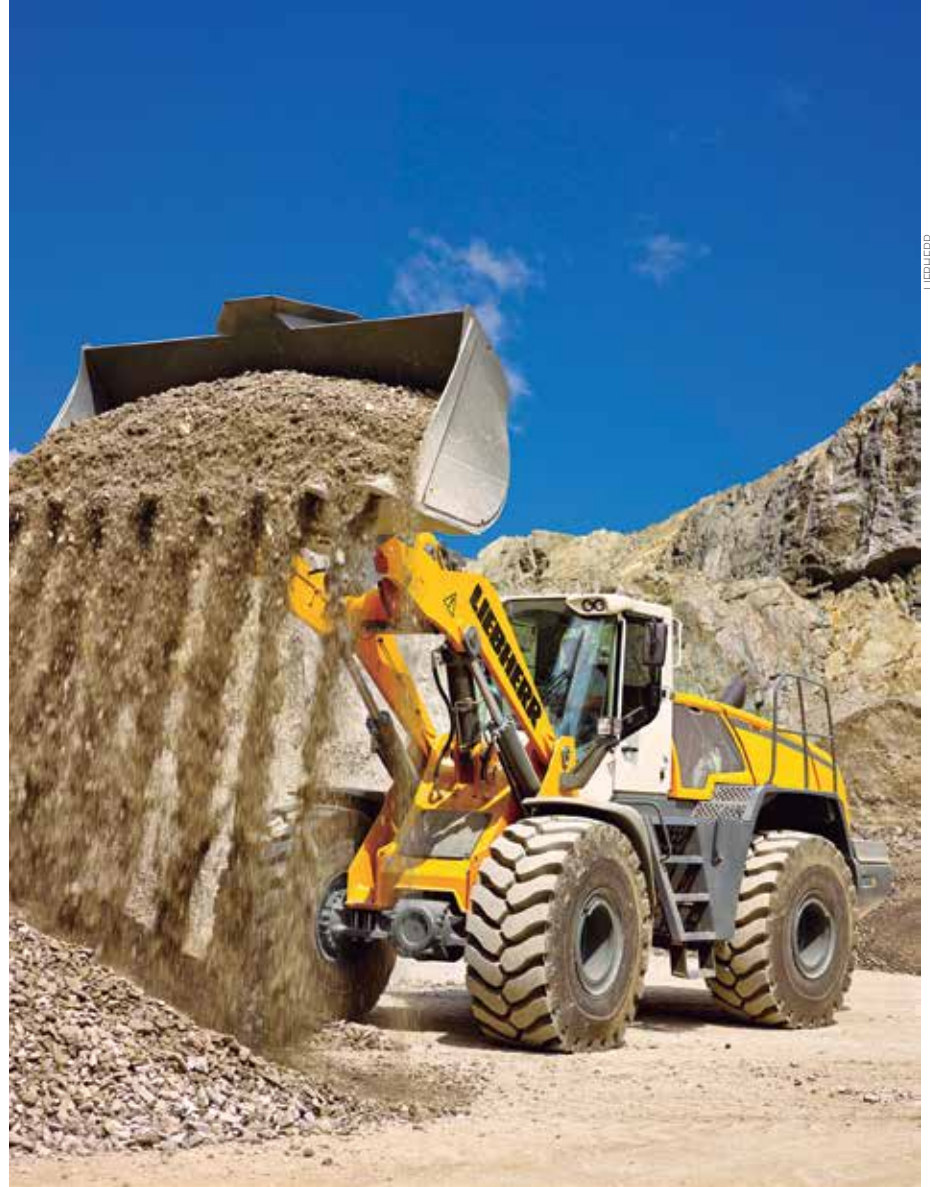
Para a caçamba, a carga de tombamento é o principal critério na hora de definir a capacidade
