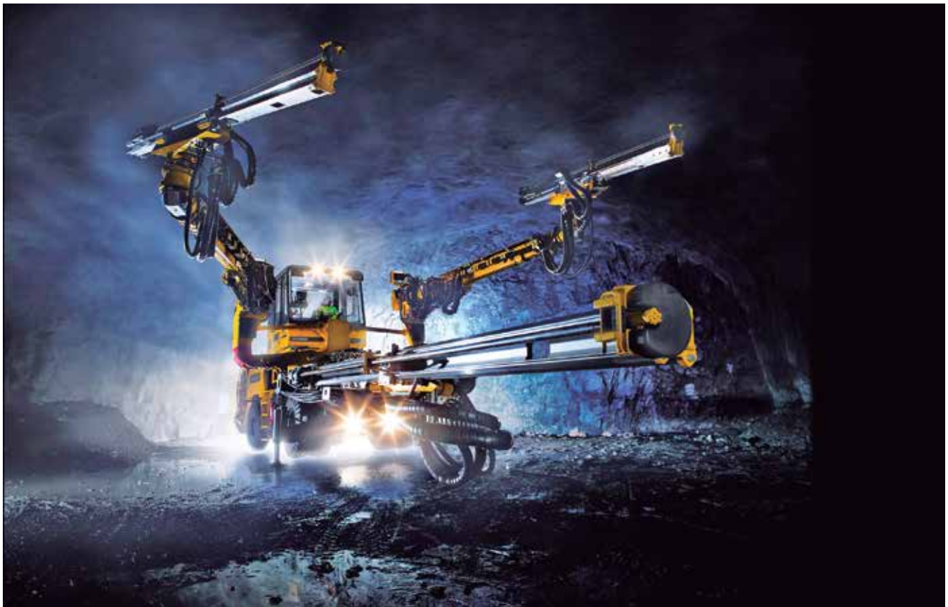
Jumbos Boomer realizam perfuração de face em obras com seções transversais de até 205 m 2
