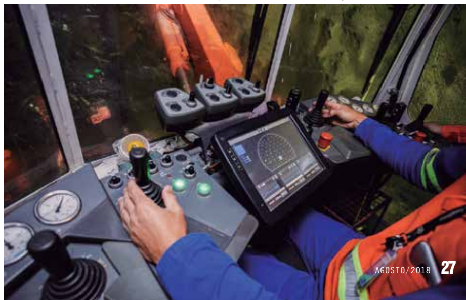
Sistemas de apoio operacional como o TCAD+ garantem a qualidade da perfuração
