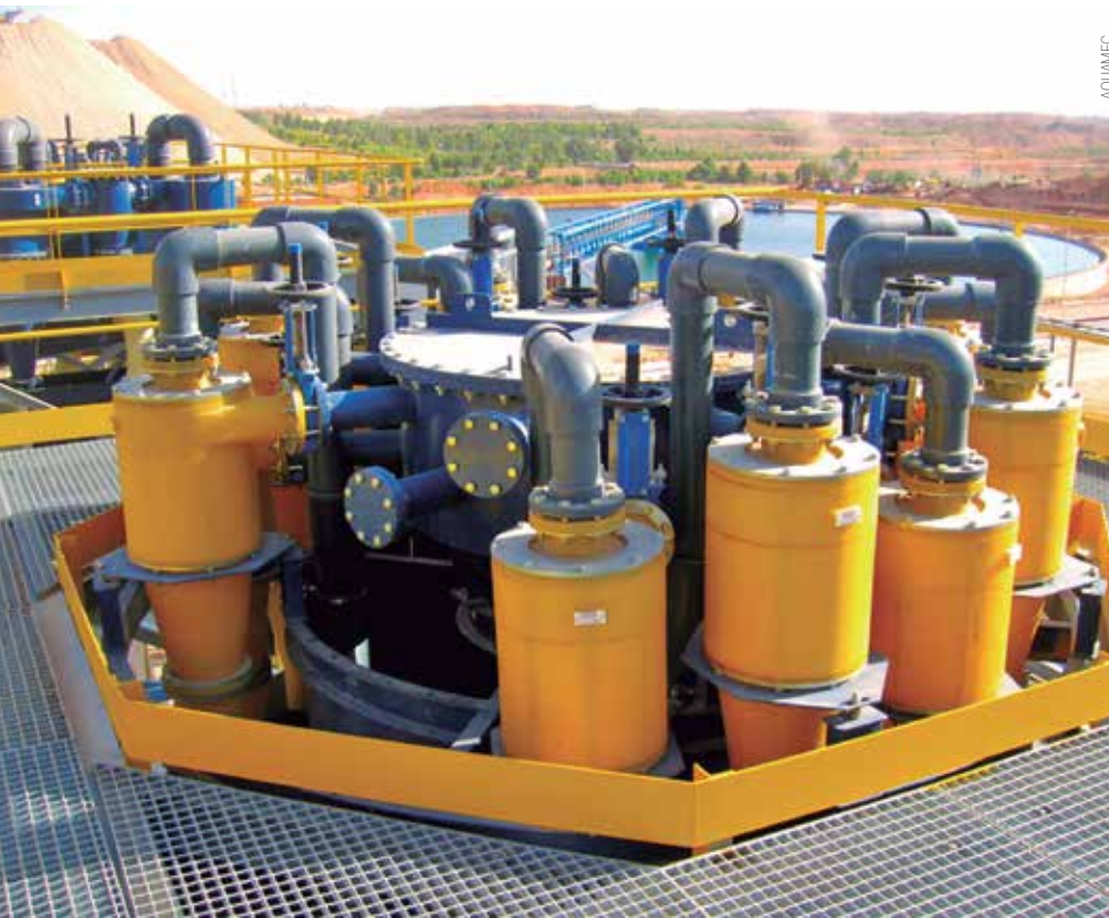
Equipamento realiza a separação de partículas sólidas e água em mineração e outros setores
