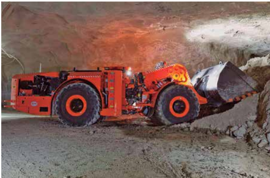
Com tecnologia híbrida, a carregadeira LHD chega em duas versões para mineração subterrânea
