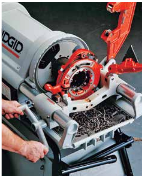
Por meio de cossinetes, a solução elétrica gira o tubo e produz a rosca por laminação
