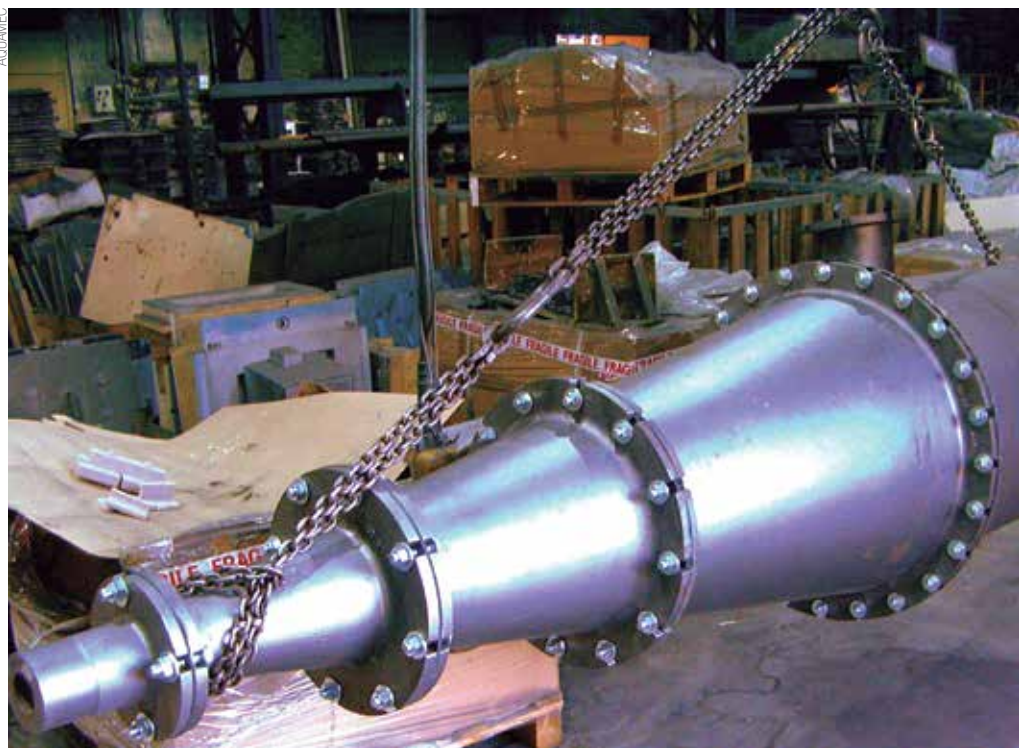
Materiais utilizados em hidrociclones incluem poliuretano, aço inoxidável e ferro fundido
