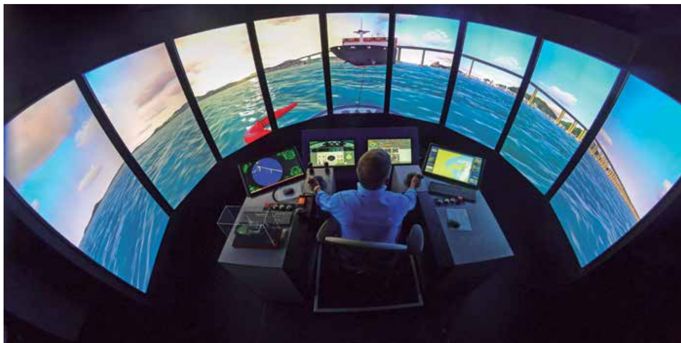
Usado para o treinamento da tripulação, simulador de manobras da Wilson Sons Rebocadores possui biblioteca com mais de 400 modelos de embarcações
