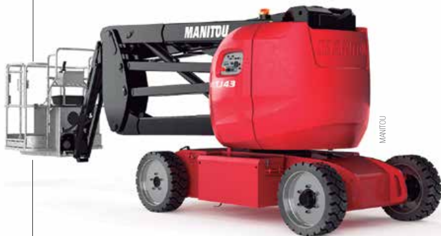
Nova linha a diesel da marca para o mercado norte-americano inclui o modelo de lança articulada AETJ 43, que possui alcance de 12,9 m
